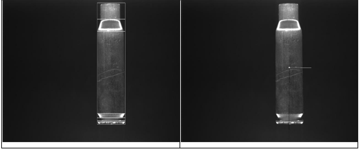
Şekil 4.3 Kovan örnek görüntüsünde PCA ile açı hesaplama
