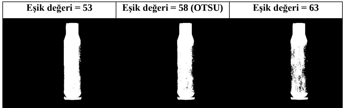
Şekil 7.4 OTSU sonucu ile yakın eşik değerlerinin karşılaştırılması
