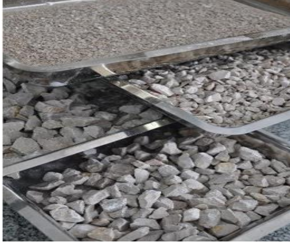
Şekil 3.2. Beton üretiminde kullanılan agregalar
