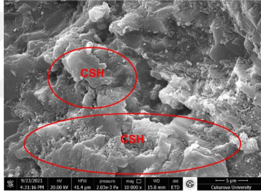
Şekil 4.70. L2 Betonunun 365 Günlük SEM Görüntüsü
