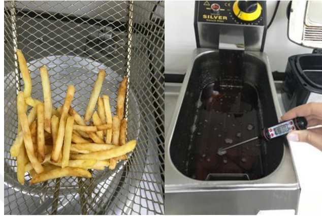
Şekil 3.5. Kızartma işleminin yapıldığı fritöz (Işıkgaz Silver, 4L) ve kızartılan patates numuneleri
