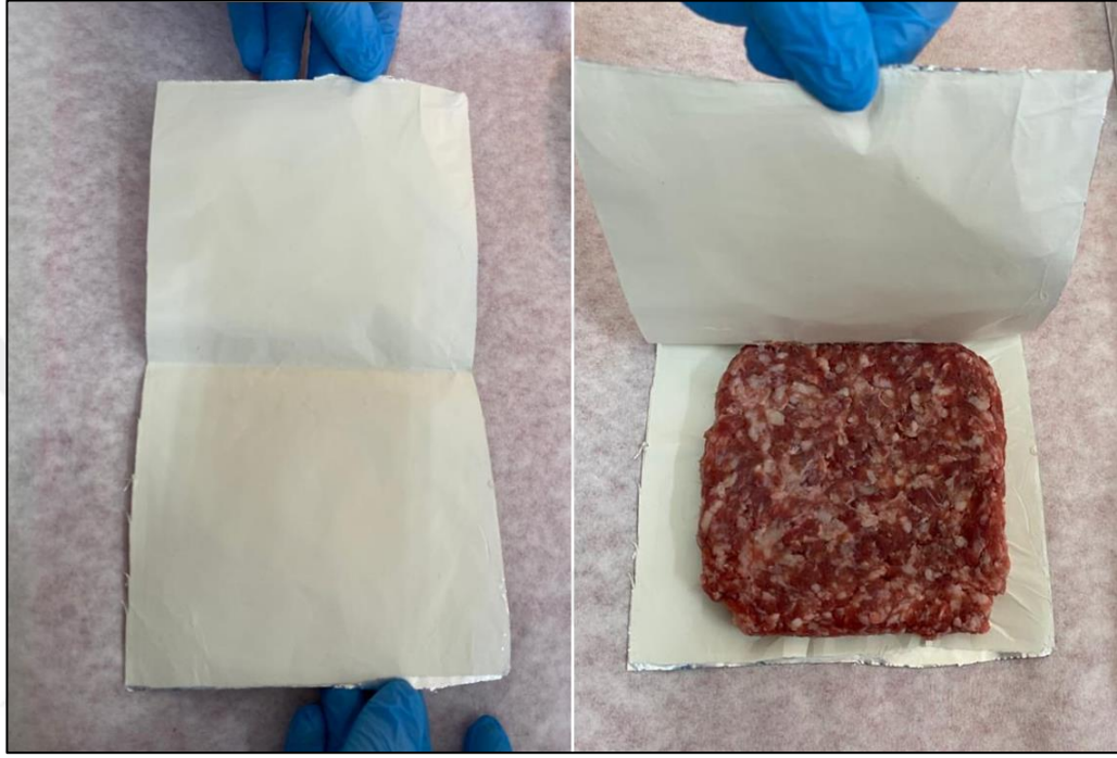
Şekil 2.2. Zein bazlı nanolif ile kıyma örneğinin ambalajlanması
