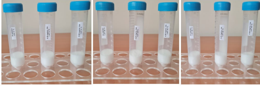
Şekil 4.21 1.ay numunelerinin faz ayrımı kontrolü
