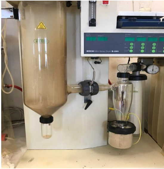
Şekil 3.1. Püskürterek kurutucu kullanılarak mikrokapsül üretimi
