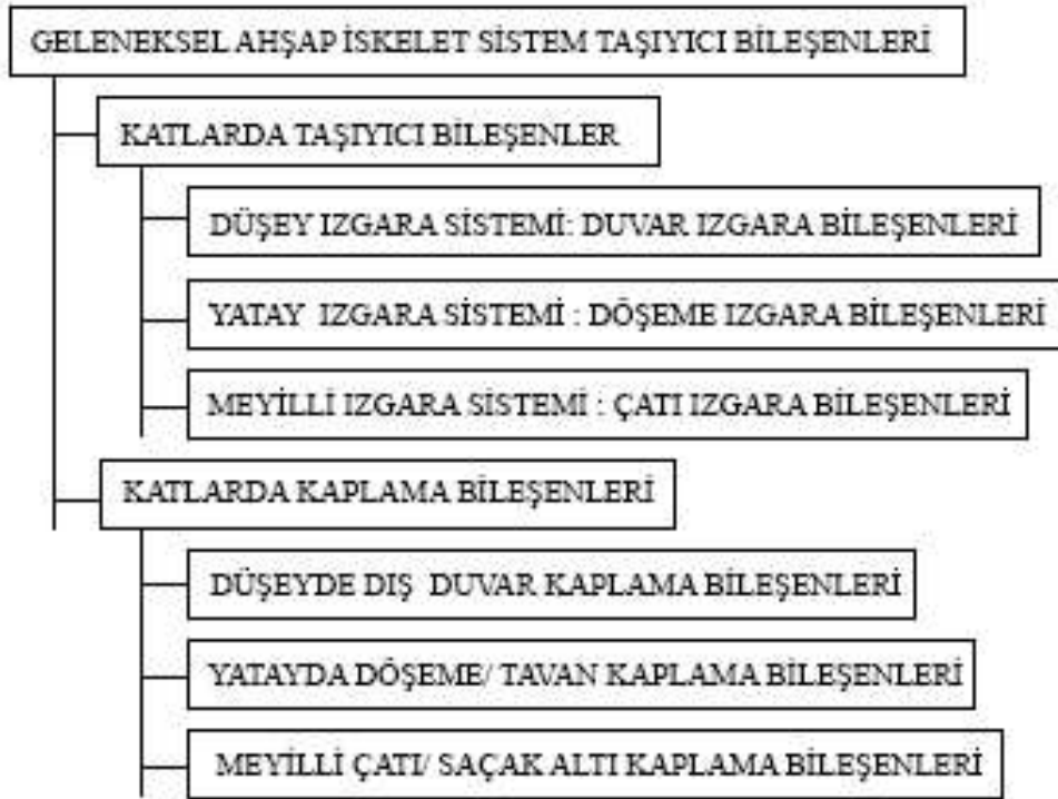
Şekil 1.1: Geleneksel ahşap iskelet sistemde taşıyıcı ahşap bileşenler
