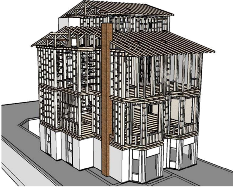
Şekil 4.29: Proje No:3 İstanbul, Bakırköy, Yeşilköy 36 Pafta/ 338 Ada/ 3 Parsel, Yapı Ahşap İskelet Sistemi Kuzey Yönünden Perspektif
