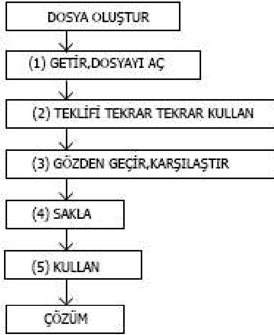
Şekil 3.2: CBR yöntemine dayalı çözüm bulma süreci.
