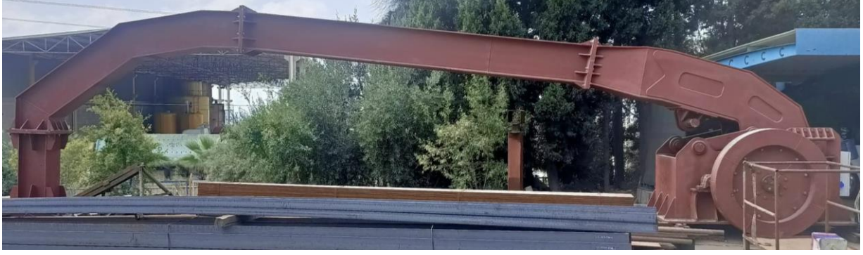
Şekil 3.102. Dalga Enerjisi Çevirici (DEÇ) sisteminin montaj fotoğrafı.
