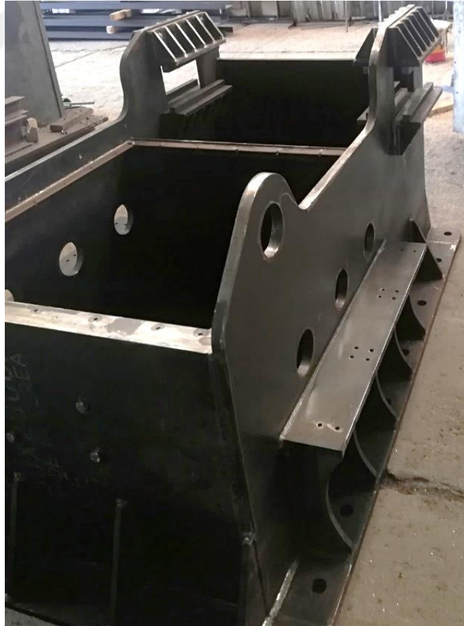
Şekil 3.97. Hareket aksamının montajının yapılacağı dişli kutusu
