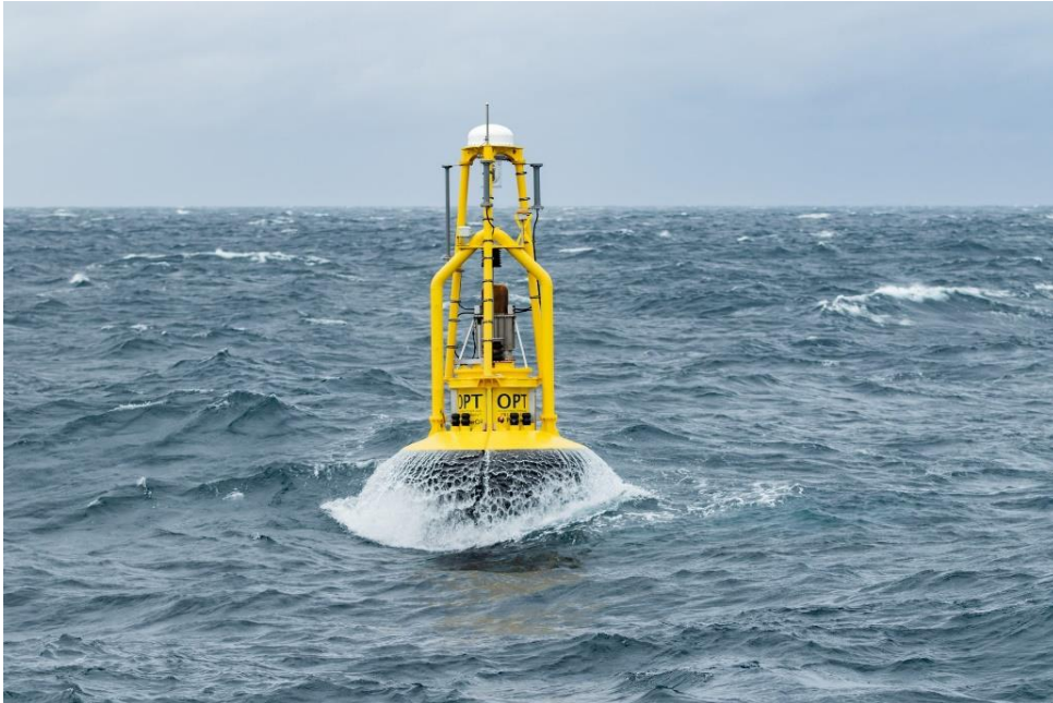
Şekil 1.3. Nokta absorblayıcı sistem örneği olan PowerBuoy isimli DEÇ ('PB3 PowerBuoy', 2022).
