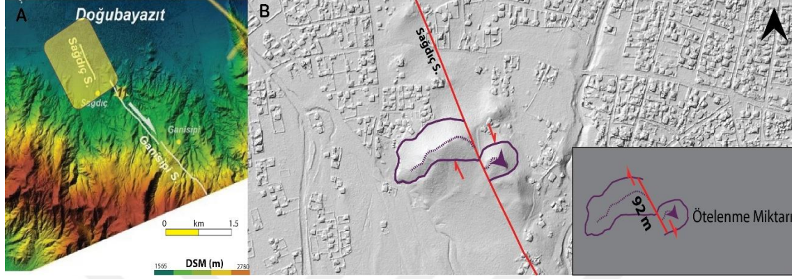
Şekil 4.19. a. Sağdıç Segmenti'nin DSM üzerinden görünümü, b. Segment boyunca meydana gelen ötelenme miktarı.
