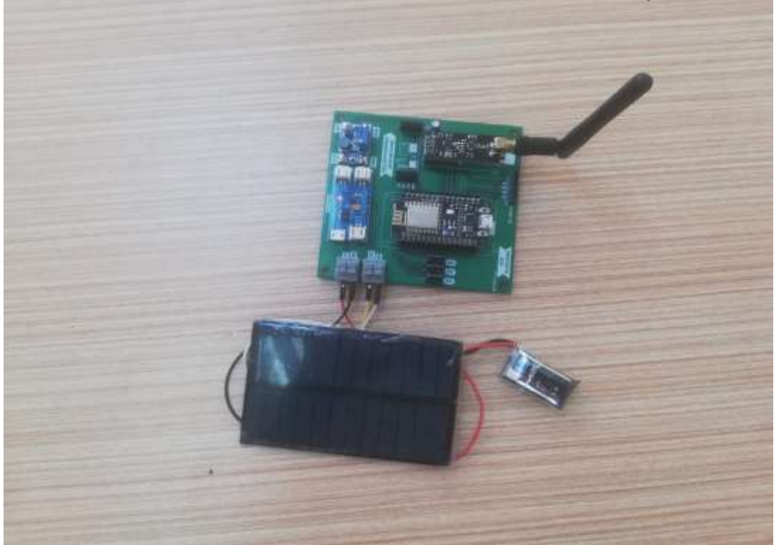
Şekil 3.5 : Sensor düğümünün tüm bileşenleri
