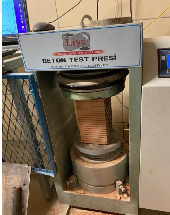
Şekil 2. Yığma Tuğlaların Basınç Dayanım Testi
