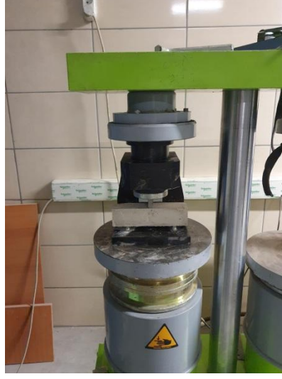
Şekil 9. Harç eğilmede çekme deneyi
