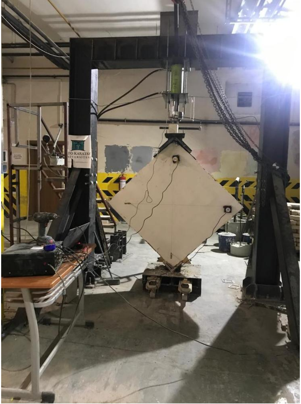
Şekil 24. V başlık altına yerleştirilmiş duvar deneyi
