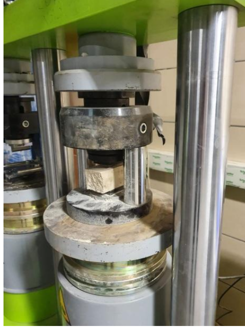
Şekil 8. Harç basınç deney düzeneği
