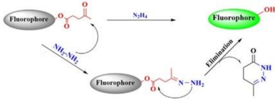
Şekil 1.13. Levulinil korumalı hidrazin sensörlerinin hidrazin eklenerek levulinil korumasının kaldırılmasına ait reaksiyon mekanizması (X. Y. Zhang ve diğerleri, 2020).
