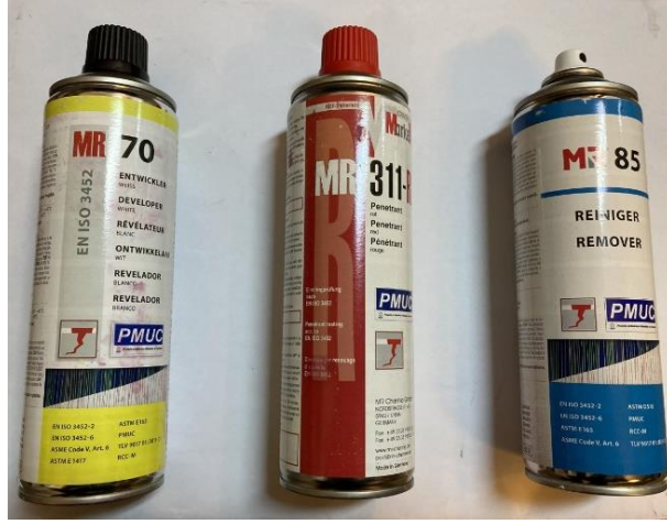
Şekil 5.7: Penetrant muayenede kullanılan sarf malzemelerin genel görünümü
