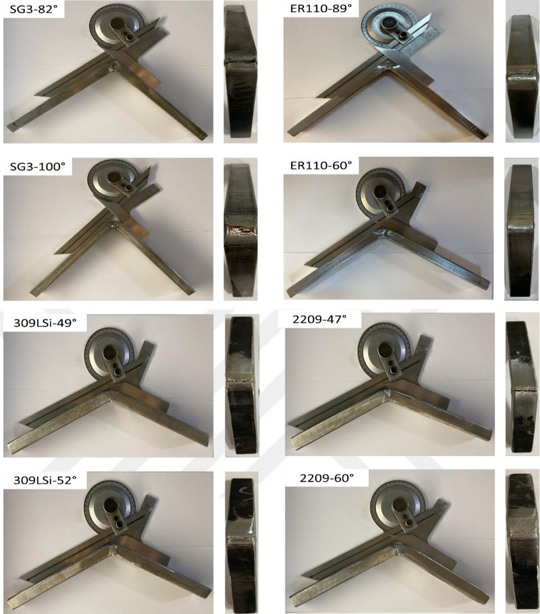
Şekil 6.10: Kaynaklı numunelerinin eğme sonuçları
