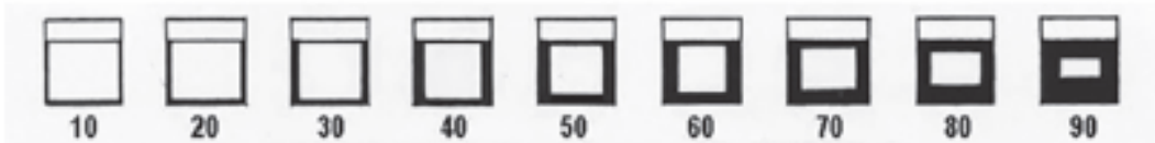
Şekil 6.7: Çentik darbe numunelerinin kırık yüzey % hesaplama standardı [73]
