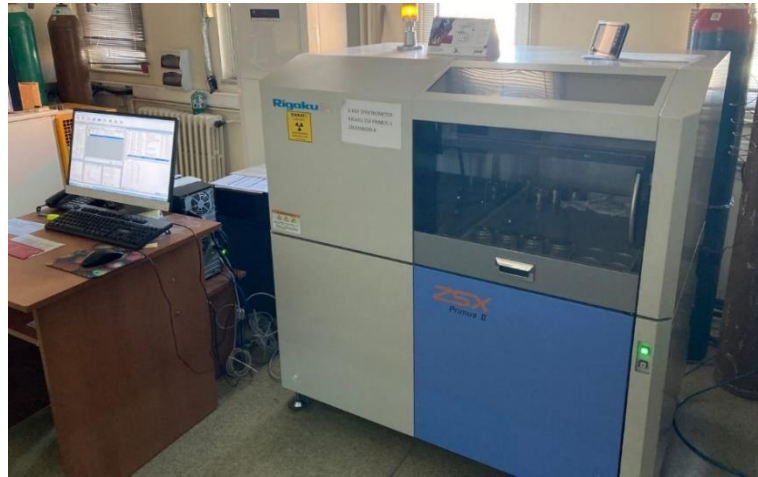
Şekil 5.26: Kimyasal analiz ölçüm cihazı (XRF)
