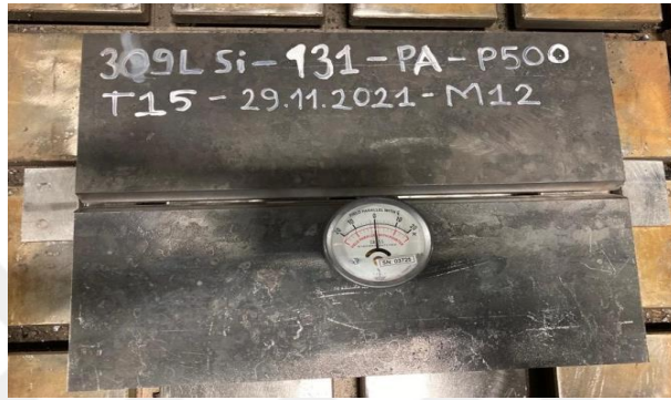
Şekil 5.4: Plakaların manyetiğini almak için kullanılan gaussmetre
