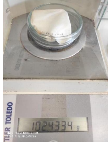
Şekil 3.6. Fusarium sp. Sus3T-3 numaralı izolatın misel kütlesinin kuru ağırlığının ölçülmesi
