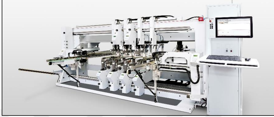
Şekil 3.2.Beslemeli delik delme makinesi (www.homag.com, 2020)
