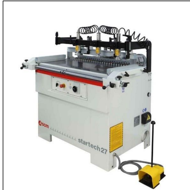
Şekil 3.1. Yarı otomatik delik delme makinesi (www.thesawcentre.co.uk, 2020)
