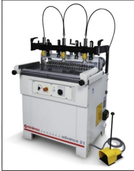
Şekil 3.4.Çoklu delik delme makinesi ( https://mktmakina.com.tr , 2020)
