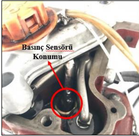
Resim 4.7. Silindir içi basınç sensör konumu ve montajı
