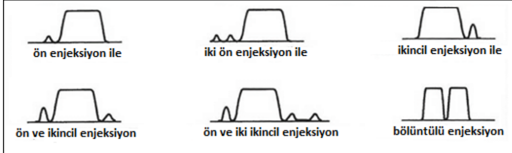
Şekil 2.18. Çoklu yakıt enjeksiyonu seçimleri [4]
