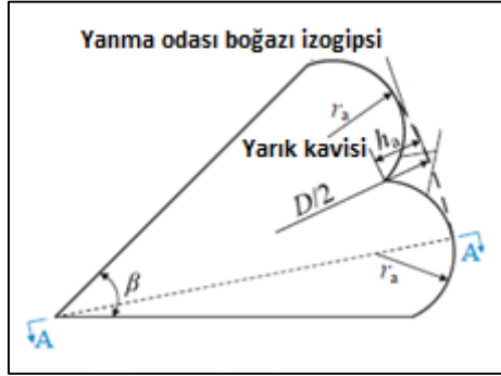
Şekil 3.10. LSCS yanma odası geometrisindeki bölünmüş akış oluşum parametreleri [45]
