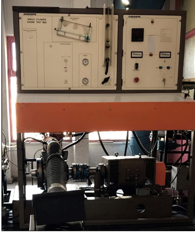
Resim 4.4. Deneyde kullanılan Cussons P8160 dinamometresi
