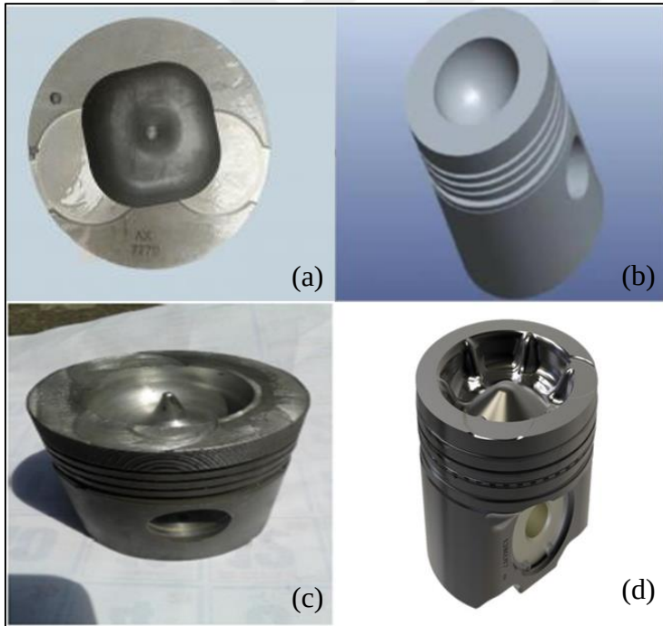
Resim 2.1.(a) Kare tip yanma odası (b) Yarı küresel tip yanma odası (c) Toroidal tip yanma odası (d) Sığ derinlikli tip yanma odası [15]
