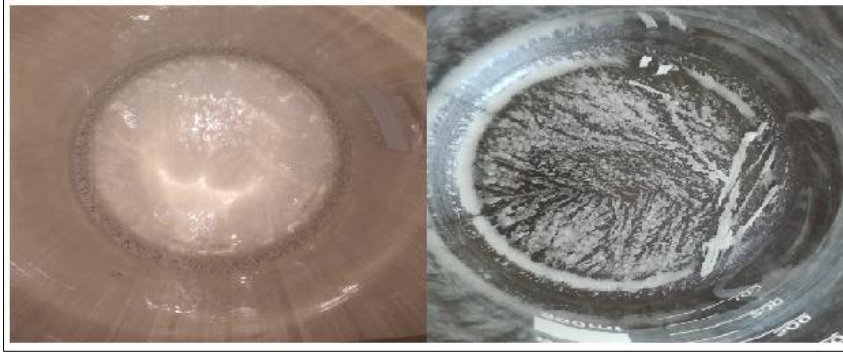
Şekil 8.6. Süzme işlemi ve yeniden kristallendirme işlemi sonrası hidrazin boran
