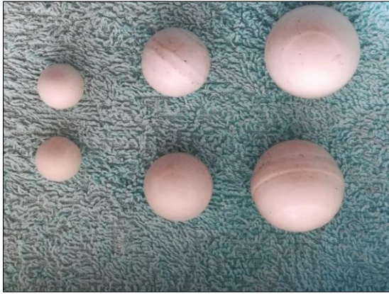
Şekil 8.5. Katı hal sentezde kullanılan küçük, orta ve büyük boy zirkonyum bilyeler
