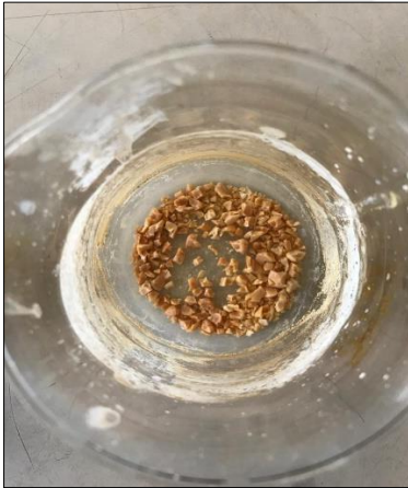
Şekil 8.1. Kuruma işlemi sonrasında elde edilen \text{TiO}_2 kompleksi
