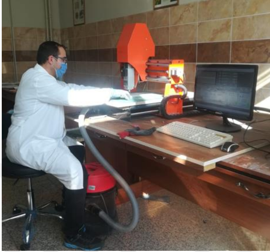
Şekil 10. CNC Router ile test numunesi kesme işlemi
