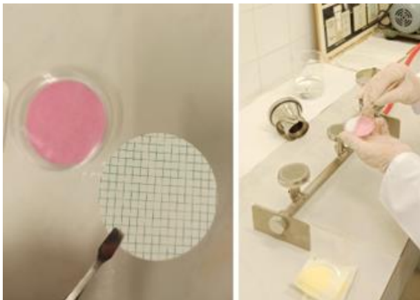
Resim 3.7. Süzdürülmüş filtrenin NKS besiyerine yerleştirilmesi
