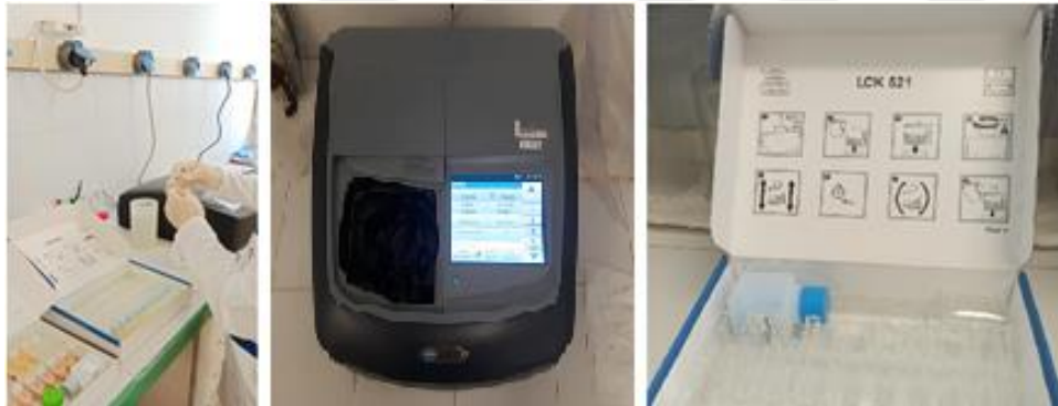
Resim 3.20. Spektrofotometrede LCK 521 kiti ile demir analizi
