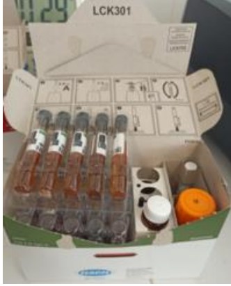
Resim 3.21. LCK 301 kiti ile alüminyum analizi
