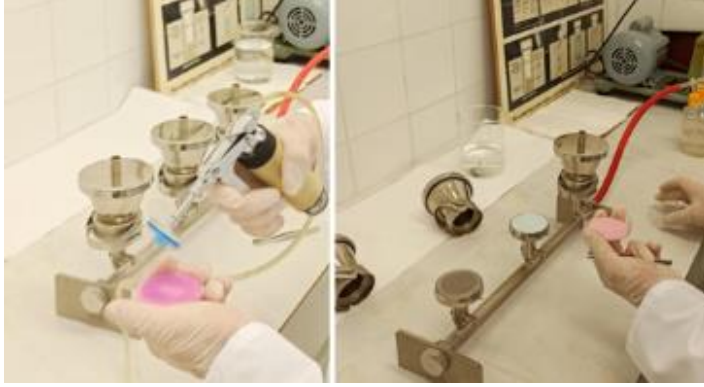
Resim 3.6. Saf su ile besiyerinin hazırlanması ve filtrenin yerleştirilmesi
