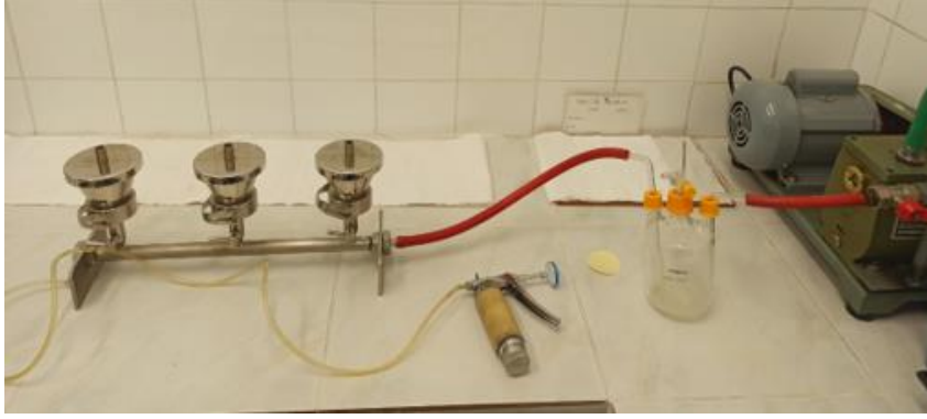
Resim 3.4. Membran filtrasyon deney düzeneği
