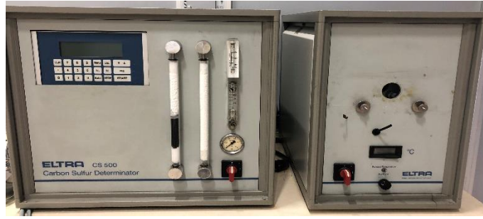
Şekil 21. Karbon siyahlarının ısıtılması için kullanılan karbon-kükürt tayin cihazı
