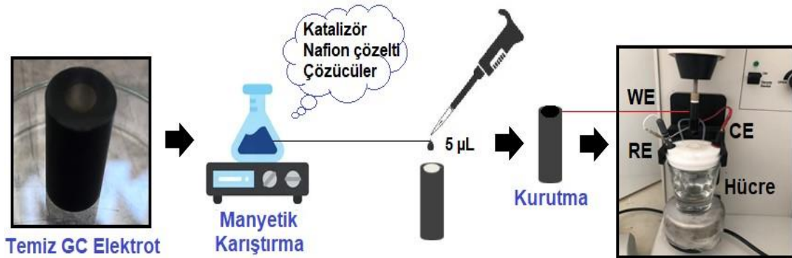
Şekil 32. Katalizörler için GC elektrotun WE olarak hazır hale getirilmesi
