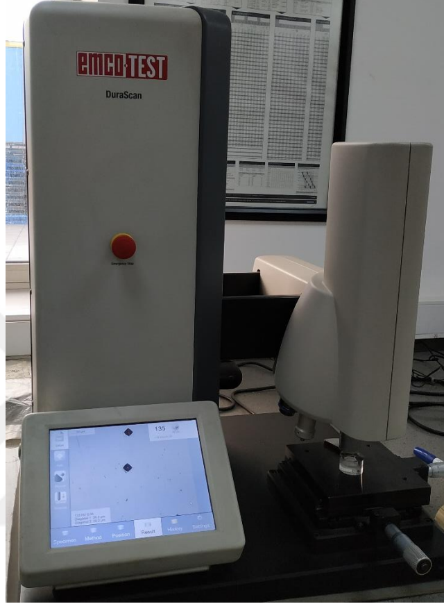
Şekil 4.5.7: Emtctest DuraScan mikro sertlik ölçüm cihazı
