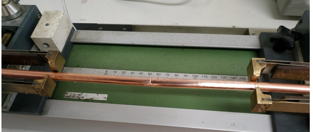
Şekil 4.3.2: Direnç Ölçüm Bölgesi ve Ölçüm Şekli
