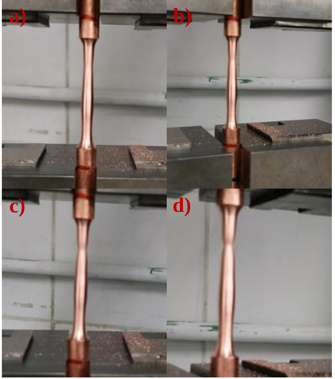
Şekil 4.6.7: Çekme numunesinin a) kopma bölgesinin değişimi-1, b) kopma bölgesinin değişimi-2, c) kopma bölgesinin değişimi-3, d) kopma bölgesinin değişimi-4
