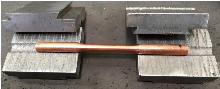
Şekil 4.6.5: Çekme Testi Deney Numunesi ve Test Çenesi
