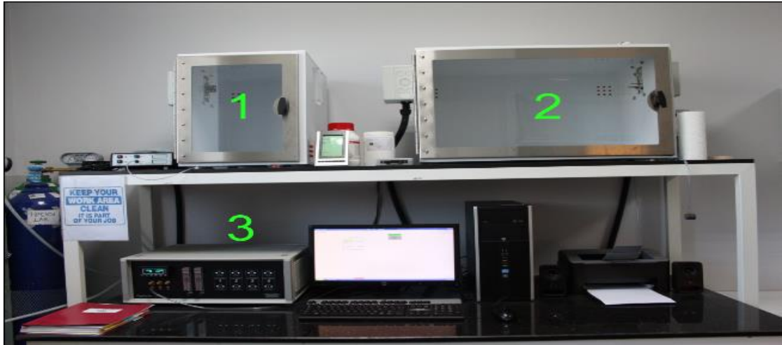
Şekil 7. Otomatik kalibrasyon ve gaz kontrol sistemli normobarik hipoksi modelleri oluşturulacak odalar (BioSpherix, NY, USA). 1) Küçük boyutlu oda (tek standart kafes için); 2) Orta boyutlu oda (iki standart kafes için); 3) Gaz değişimi için kullanılan otomatik kalibrasyon ve gaz kontrol sistemi cihazı.
