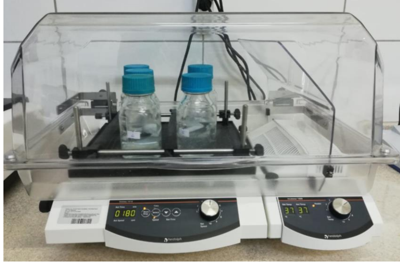
Şekil 3.4. Heidolph marka Unimax 1010 çalkalamalı inkübatör
