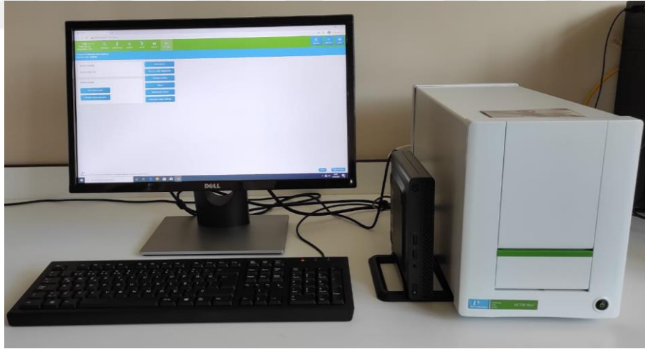
Şekil 3.5. Perkin Elmer marka Victor Nivo model salım analiz cihazı
