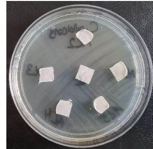
Şekil 4.29. YA ve AL etken madde içeren nanoliflerin antimikrobiyal aktivitesinin disk difüzyon test yöntemi ile değerlendirilmesi
