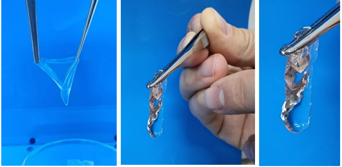
Şekil 4.2. Çapraz bağlanmış PAA esaslı nanoliflerin 24 saat saf su içerisinde bekletilmesi sonrasındaki görüntüleri
