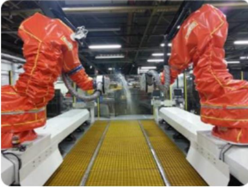
Resim 4.2. TECNATOM ultrasonik tarama robotu (TTU Modu) (Tecnatom, 2022)
