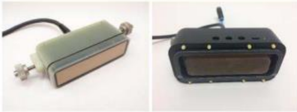
Resim 2.1. Düşük frekanslı fazlı dizi probu ve prob tutucusu (Lamlara, 2017)
