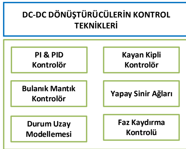
Şekil 3.1 : DC-DC dönüştürücülerin kontrol teknikleri.
