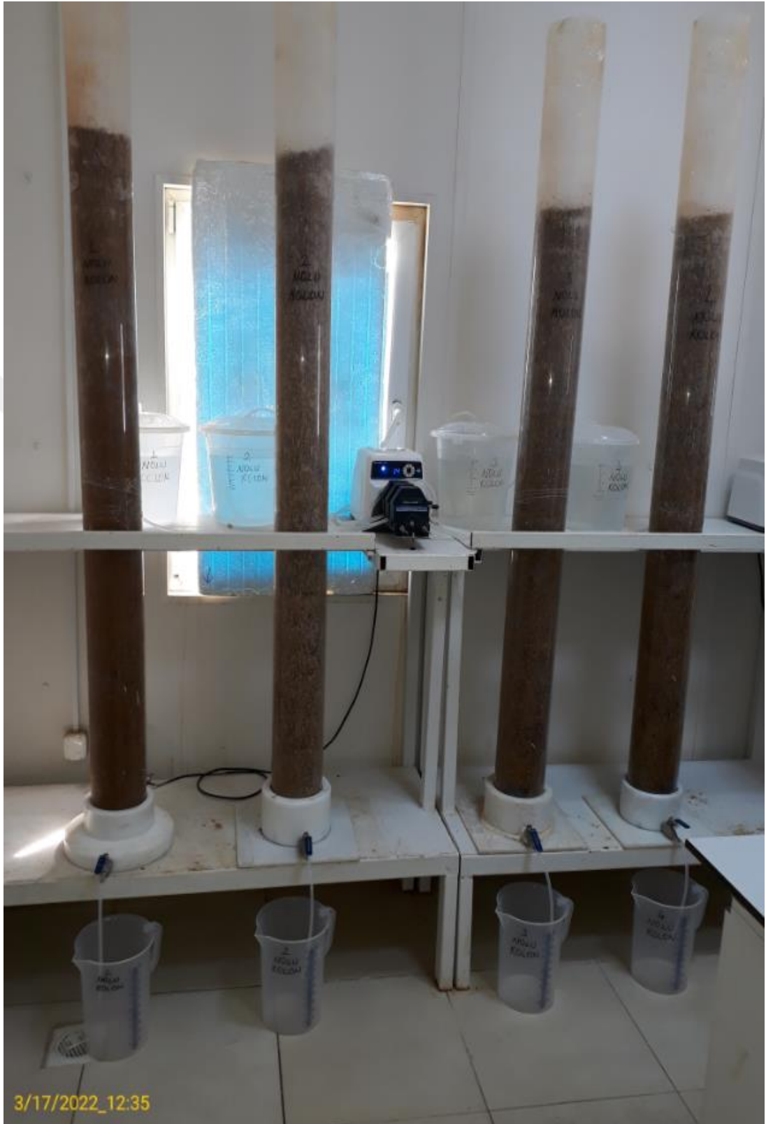
Şekil 17. Kolon Testlerinin Başlatıldıktan Sonraki Görünümü
