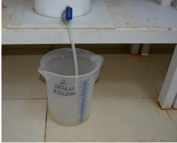
Şekil 21. Kolon Yıkama Suyu Beheri – Kolondan Toplanan
