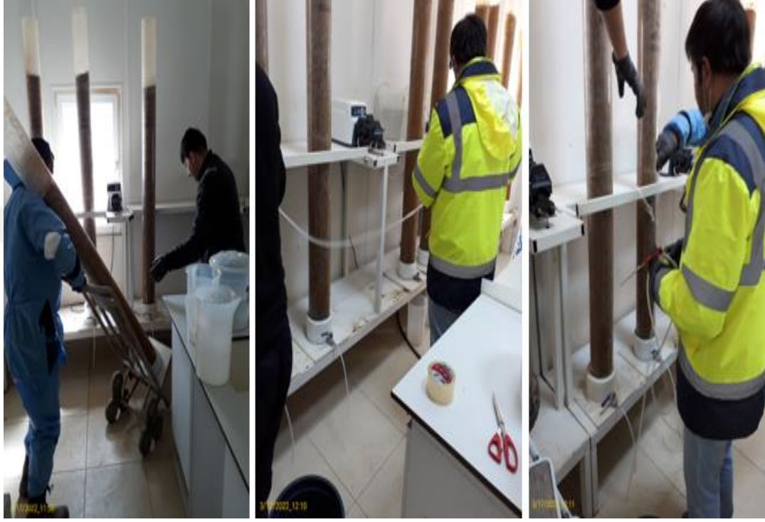
Şekil 15. Kolon Bağlantılarının Yapılması
