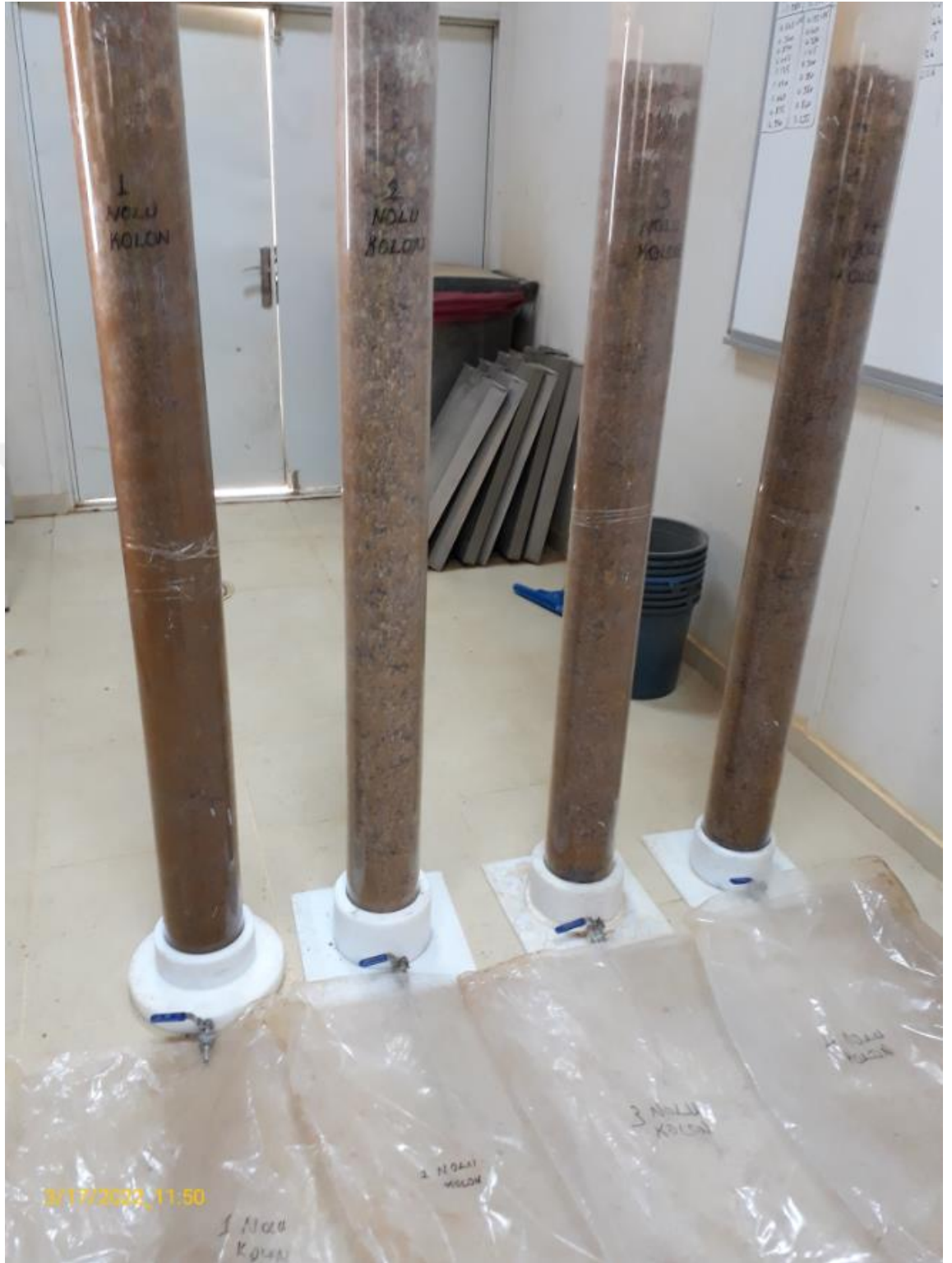
Şekil 14. Numuneler İle Yüklenmiş Kolonlar
