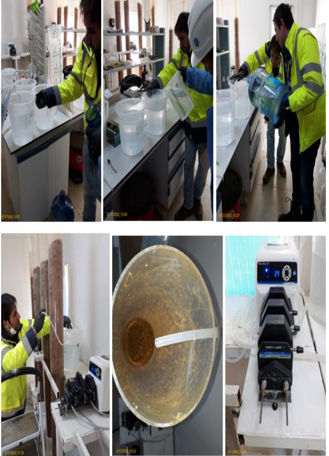
Şekil 16. Besleme Sularının Tesisi ve Peristaltik Pompa Bağlantıları
