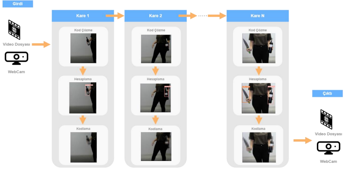
Şekil 3.28. Klasik nesne tespiti için kullanılan mimari
