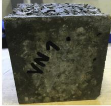
Şekil 2.1 Aşırı çimento hamurunun aşağıya doğru akması (Kia et al., 2017).
