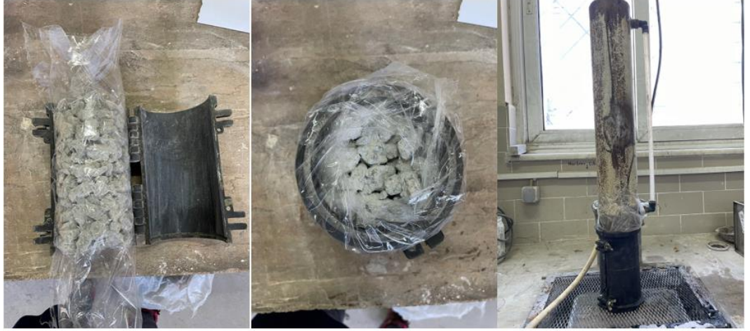
Şekil 3.6 Su geçirimliliği katsayısı hesaplamasında kullanılan düzenek.
