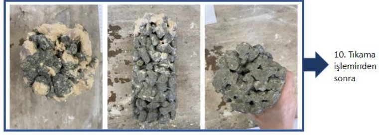
Şekil 4.45 Tıkama sonrası numune yüzeylerindeki değişim.
