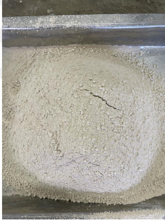
Şekil 3.13 Tıkama işleminde kullanılan kil.
