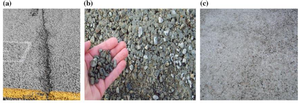
Şekil 2.3 Geçirimli betonlarda görülen bozulmalar (Chandrapa and Biligiri, 2016).
