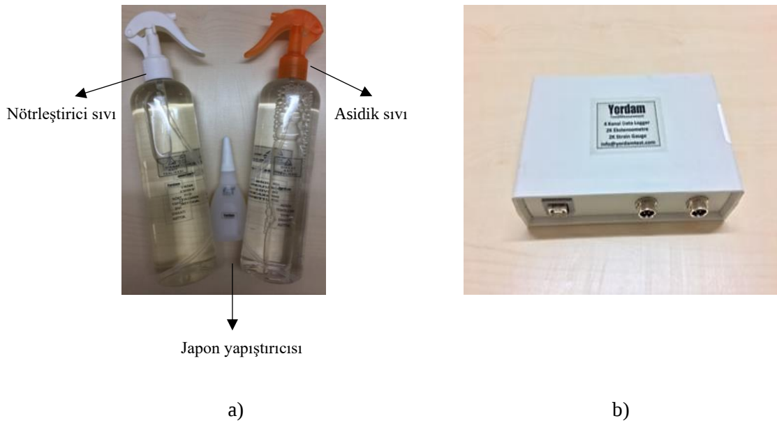
Şekil 5.18. a) Yapıştırıcı ve yüzey hazırlama sıvıları, b) veri okuma cihazı
