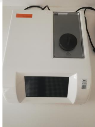
Şekil 2.2. Kırılma indisi ölçümü yapılan refraktometre cihazı
