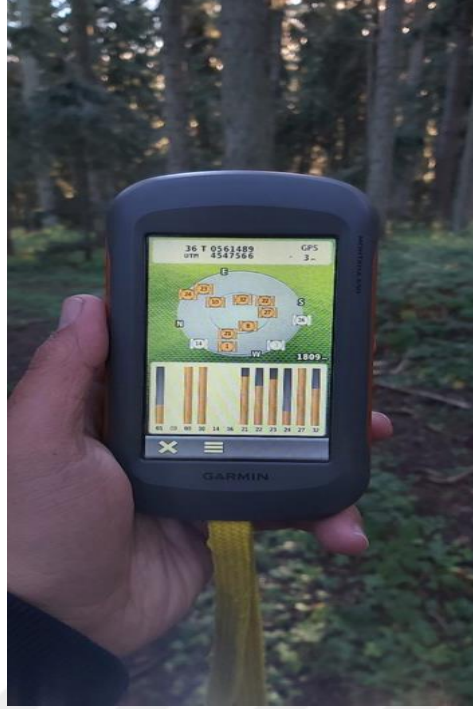
Şekil 3.4 Referans noktaların koordinatlarının gsp yardımıyla alınması
