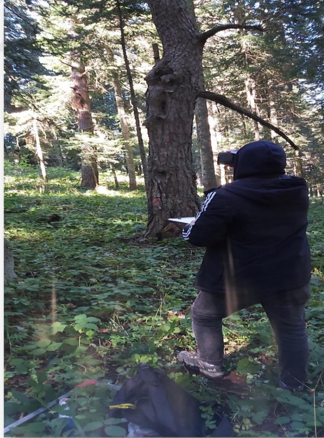
Şekil 3.5 Ağaçların merkez noktasına olan uzaklığının lazer metre ile ölçülmesi
