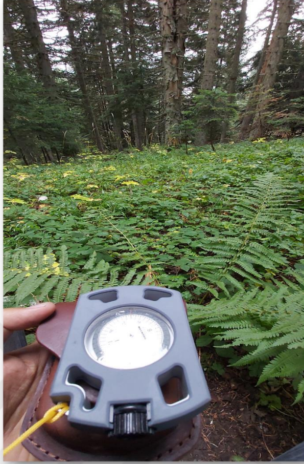
Şekil 3.6 Pusula ile ağaçların referans noktasına olan sapma açılarının ölçülmesi
