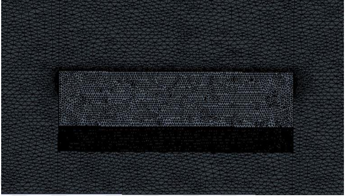
Şekil 2.9: Kavite geometrisinin yapısal olmayan sayısal ağ yapısı örneği.
