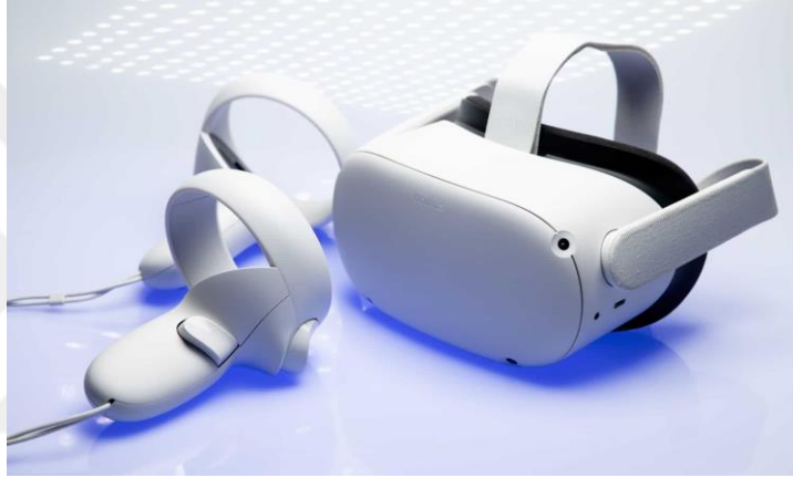
Fotoğraf 1.2. Kendinden işletim sistemli sanal gerçeklik gözlüğü
