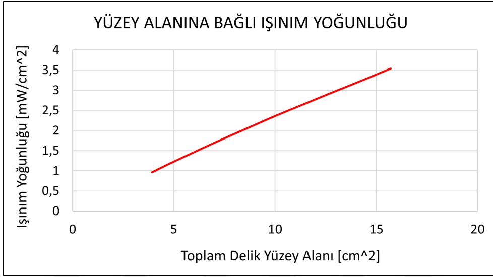
Şekil 4.13 : Silindirik delik tipi için toplam yüzey alanına bağlı enerji kaybı grafiği.
