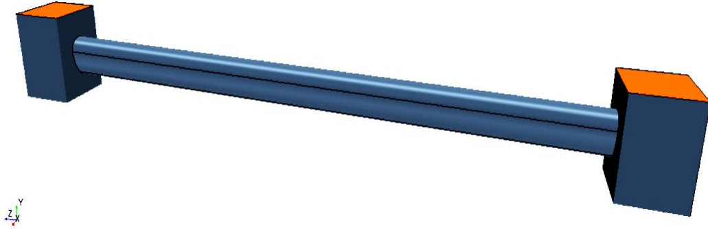
Şekil 4.15 Giriş ve çıkış menhollü yumurta kesitli boru hattı
