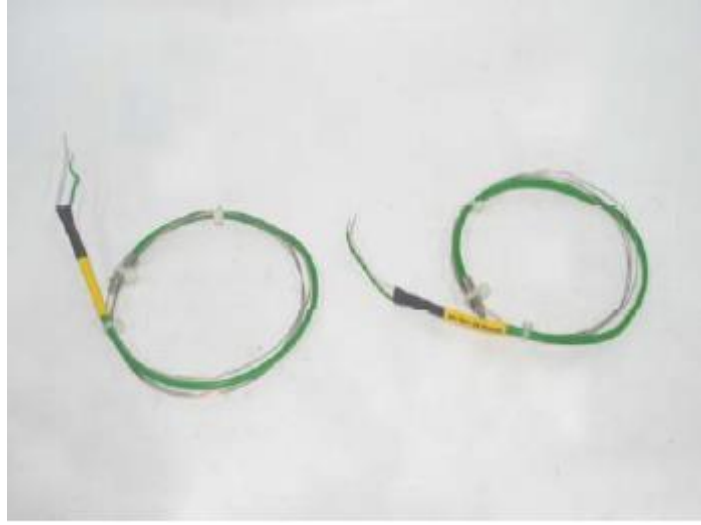
Şekil 2.29. Numunelerin ölçümünde kullanılan termal çiftler.
