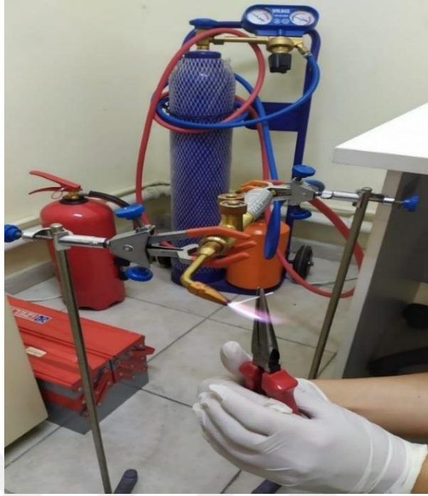
Şekil 2.25. Oksijen kaynağı yardımıyla alümina tüpün kapatılması.
