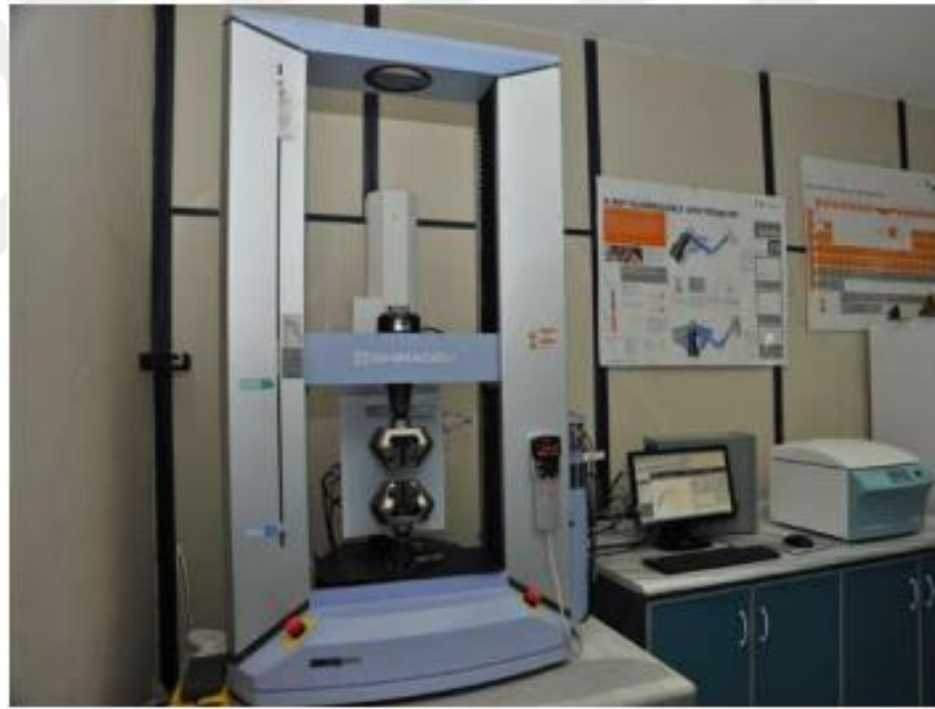
Şekil 2.22. Çekme-dayanımı test ölçüm cihazının fotoğrafı [115].
