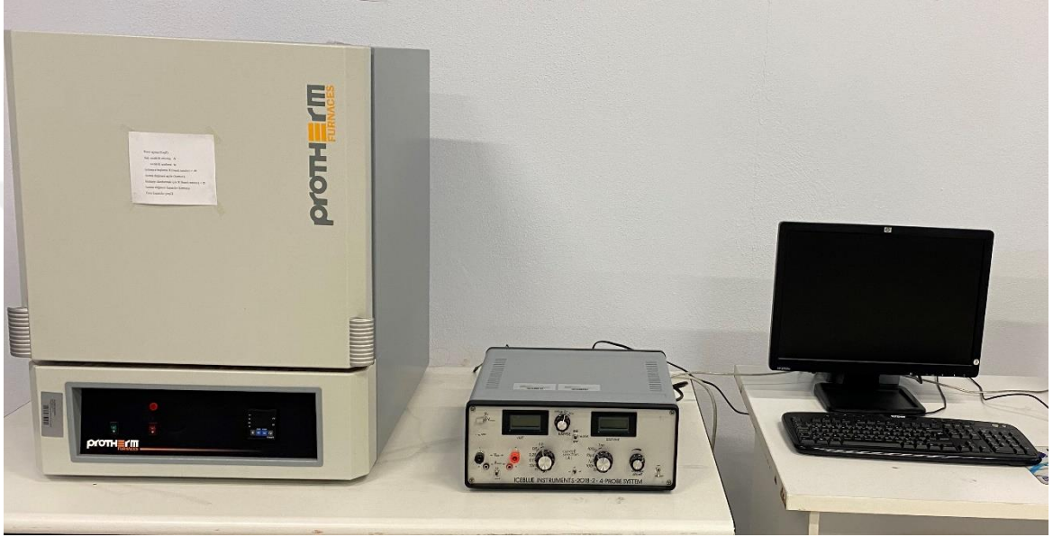
Şekil 2.32. Elektriksel özdirenç/iletkenlik ölçüm düzeneği.
