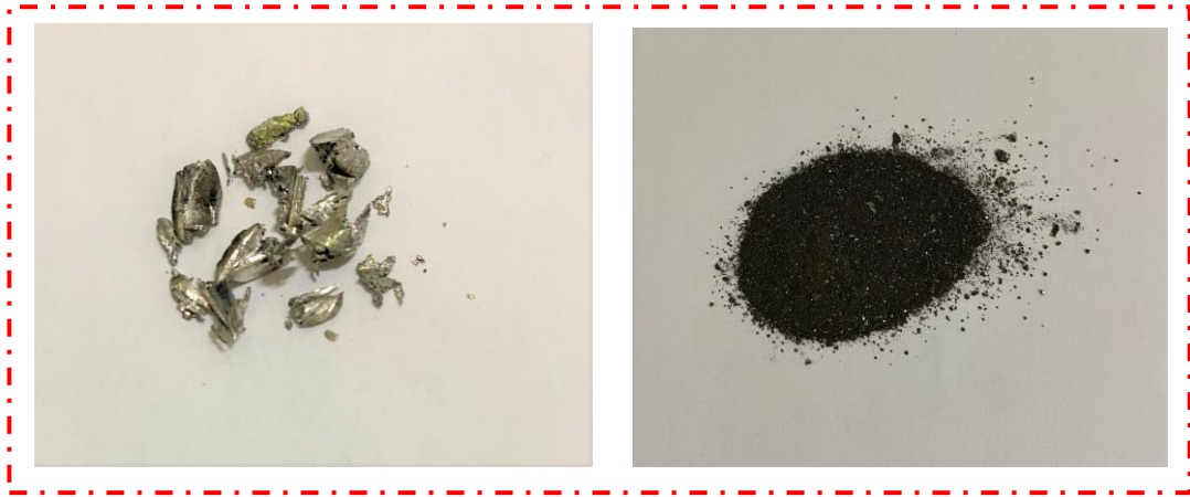
Şekil 2.20. (a) Öğütme işlemi öncesi alaşım (b) öğütme işlemi sonrası toz alaşım.
