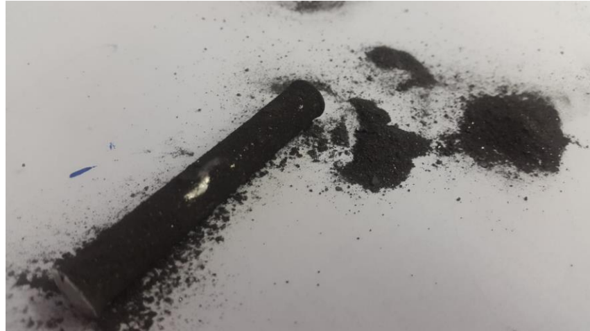
Şekil 2.19. Öğütme sonrası çelik üzerinde kalan toz parçacıkları.
