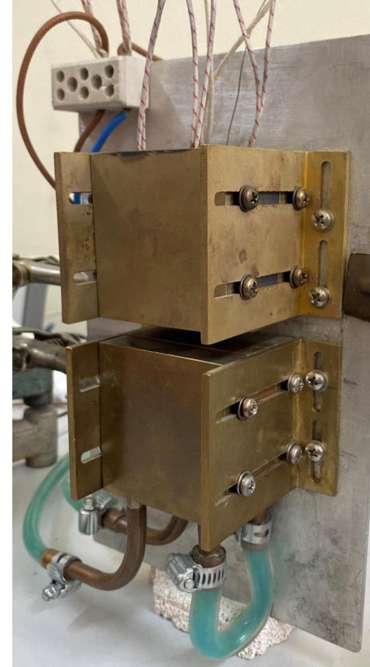
Şekil 2.5. Soğutucu-ısıtıcılı sıcaklık gradyenti sisteminin genel görünüşü [81] ve fotoğrafı.
