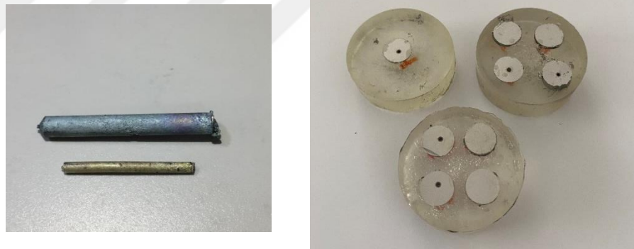
Şekil 2.11. (a) Dökümü sonrası numuneler (b) epoksi-resin ile kalıplanmış olan numuneler.
