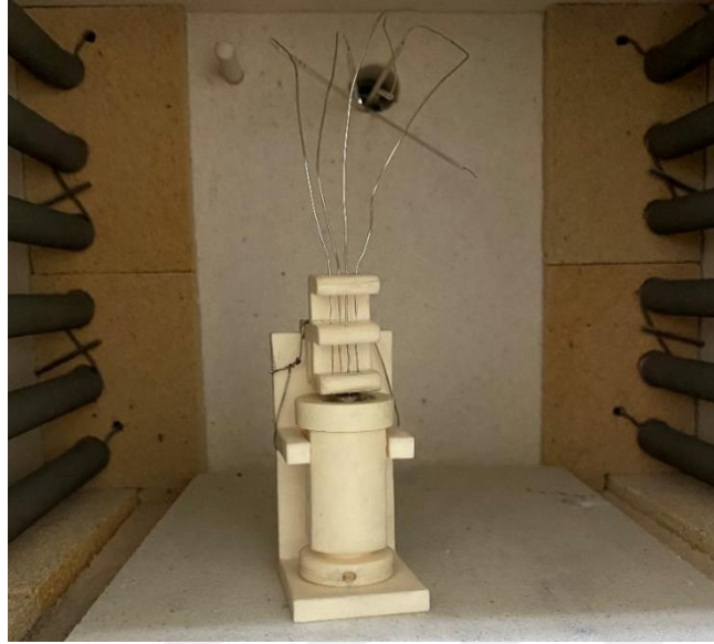
Şekil 2.33. Elektriksel öz direnç/iletkenlik numune tutucusu.
