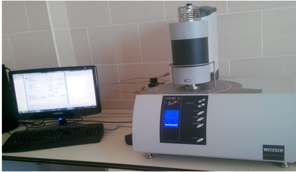
Şekil 2.9. Diferansiyel taramalı kalorimetre cihazı.
