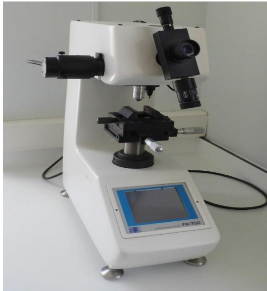
Şekil 2.21. Mikrosertlik ölçüm cihazı [116].
