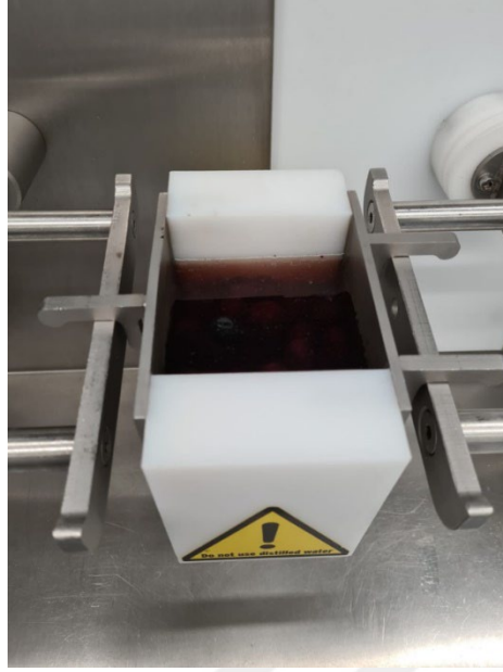
Şekil 3.4. Zeytinlere PEF uygulama haznesi
