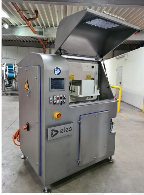
Şekil 3.2. PEF cihazı katı ürün uygulama odacıđı
