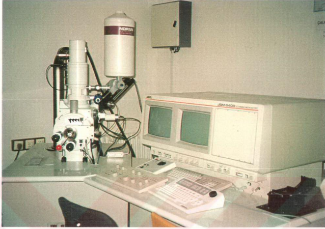
Şekil 3.8. Tarama Elektron Mikroskobu (Jeol, JSM-6400, Norao Instruments, JAPAN)
