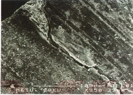
Şekil 4.20. Birinci grupta Charisma ile hazırlanan bir örneğin okluzal bölgedeki diş-restorasyon birleşiminin görünümü (x350 büyütme)
