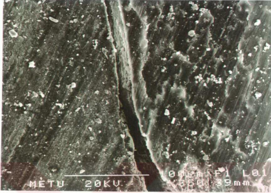
Şekil 4.18. Birinci grupta Tetric ile hazırlanan bir örneğin okluzal bölgedeki diş-restorasyon birleşiminin görünümü (x350 büyütme)
