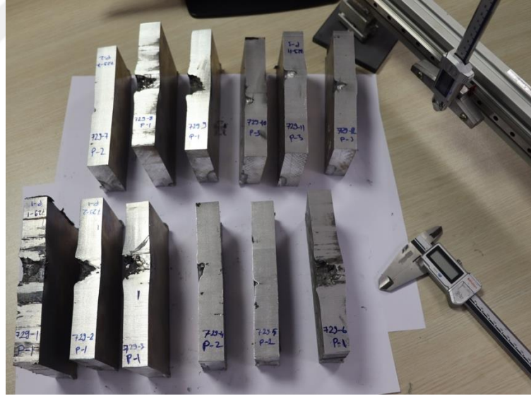
Şekil 5.6: Her bir Atışta Merminin Nüfuz Ettiği Son Destek Plakasının Ara Kesiti.
