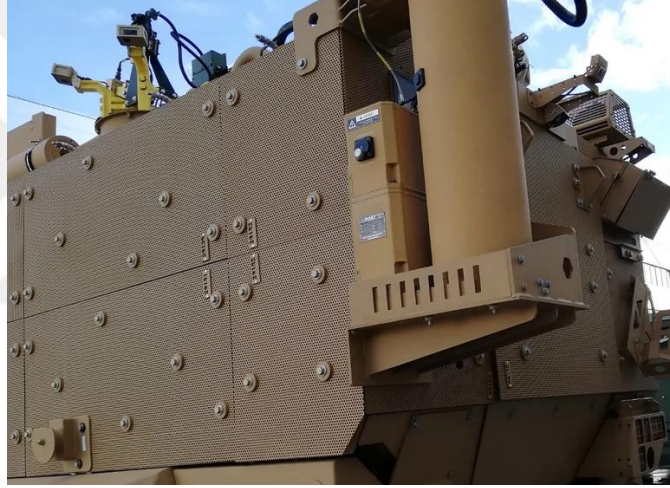
Şekil 2.5: Delikli Metalik Zırh.
