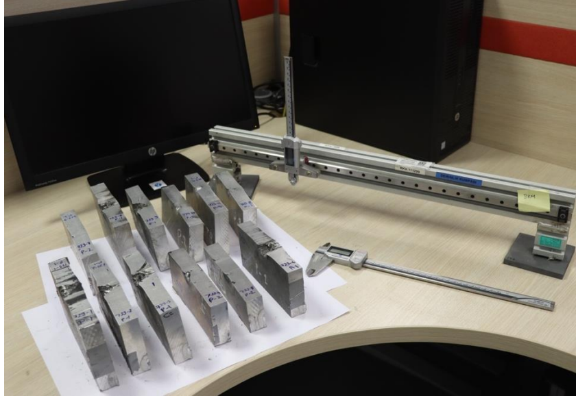
Şekil 5.7: Kesilen Plakalardan Delme Derinlik Ölçümü.
