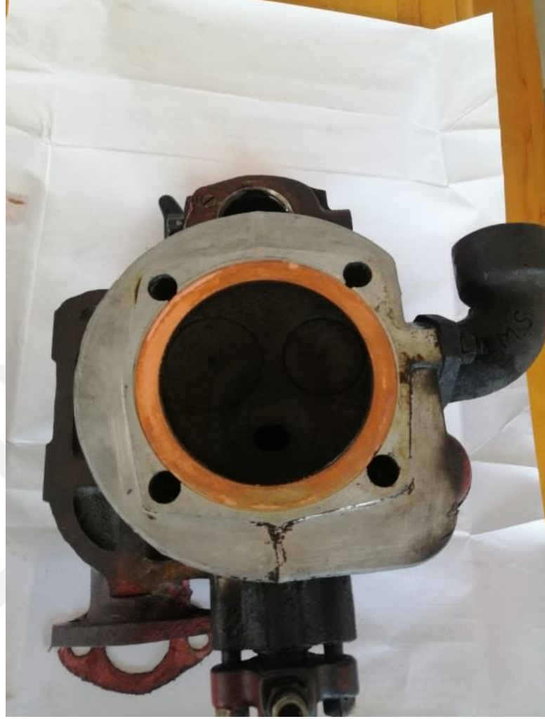
Şekil 6. 25. 60 saatlik D25ALY75 yakıtıyla çalışma sonucunda silindir üst kapağının görünüşü
