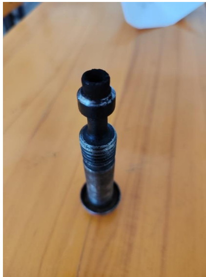
Şekil 6. 39. 60 saatlik D25ALY75DEE7 yakıtıyla çalışma sonucunda ateşleme fitilinin görünüşü
