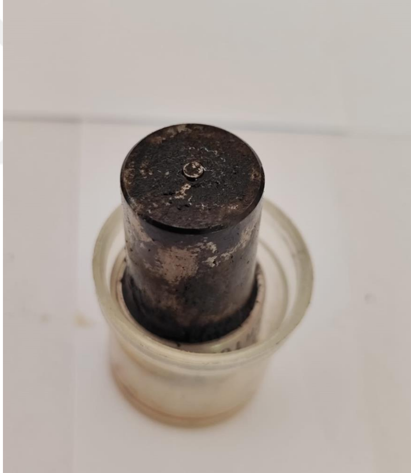
Şekil 6. 42. 60 saatlik D25ALY75DEE7 yakıtıyla çalışma sonucunda enjektör memesi görünüşü
