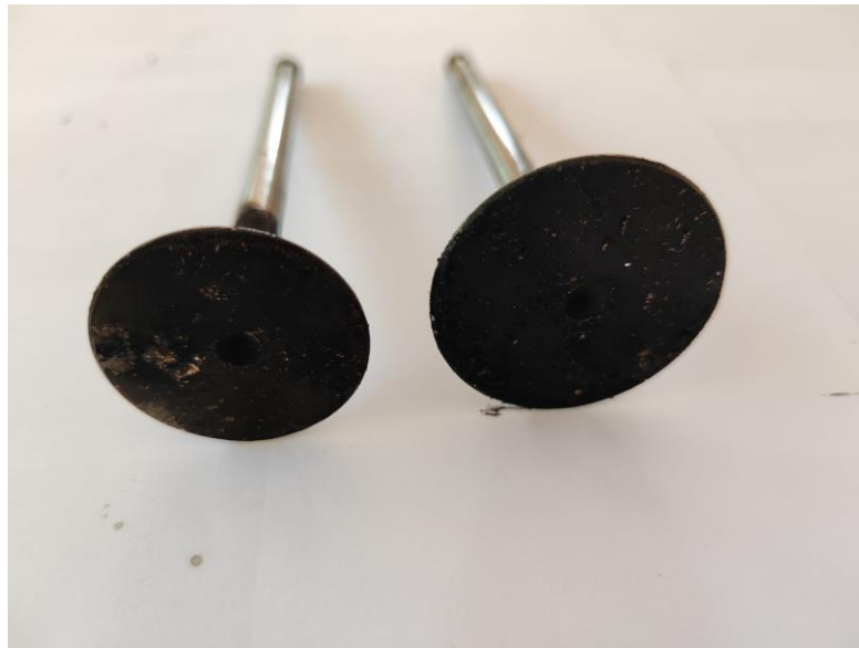
Şekil 6. 17. 60 saatlik D100 yakıtıyla çalışma sonucunda emme ve egzoz supabının görünüşü
