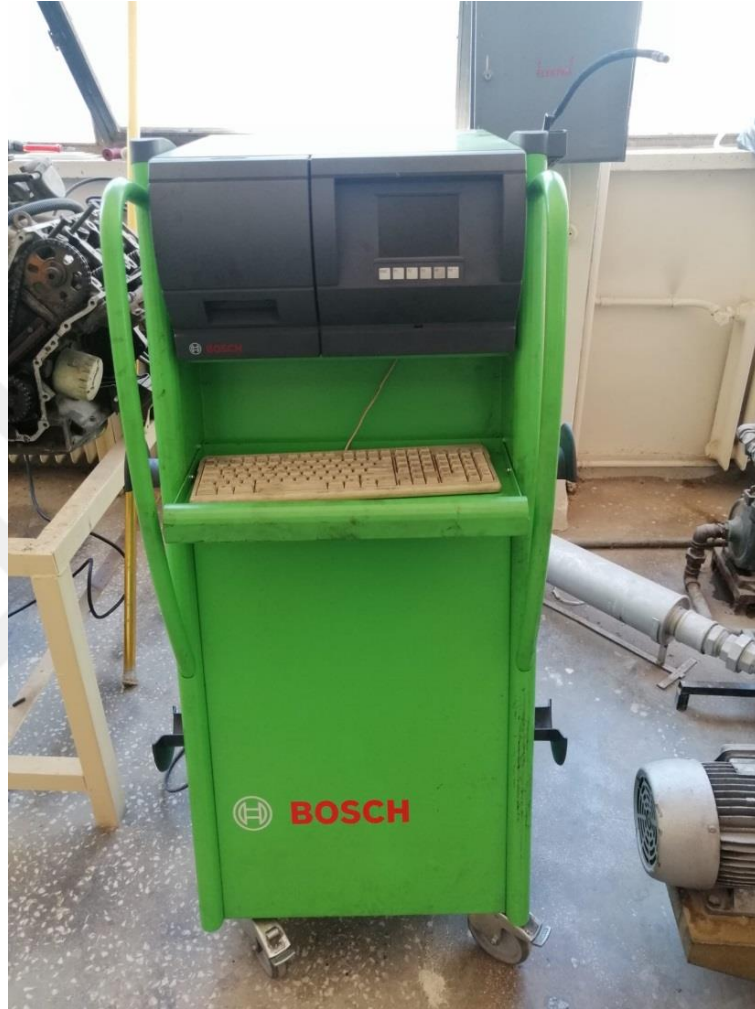
Şekil 5. 6. BOSCH marka egzoz emisyon ölçüm cihazı
