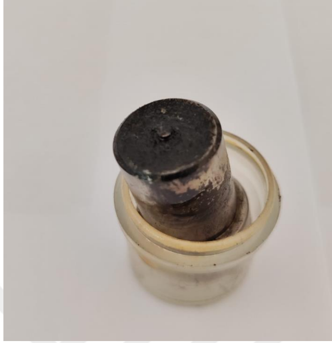
Şekil 6. 32. 60 saatlik D25ALY75 yakıtıyla çalışma sonucunda enjektör memesi görünüşü
