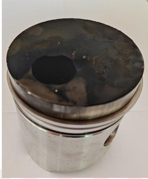
Şekil 6. 20. 60 saatlik D100 yakıtıyla çalışma sonucunda piston görünüşü
