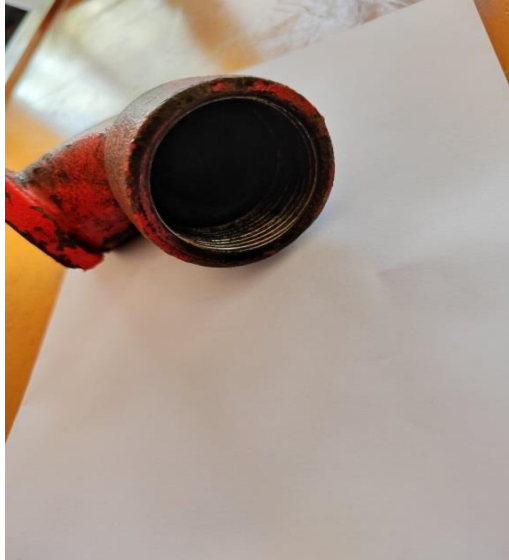
Şekil 6. 23. 60 saatlik D100 yakıtıyla çalışma sonucunda egzoz manifoldunun görünüşü
