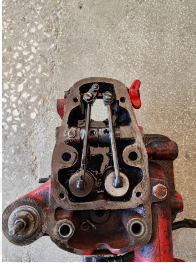
Şekil 6. 24. 60 saatlik D100 yakıtıyla çalışma sonucunda külbütörlerin görünüşü
