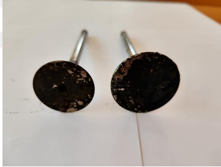
Şekil 6. 37. 60 saatlik D25ALY75DEE7 yakıtıyla çalışma sonucunda emme ve egzoz supabının görünüşü
