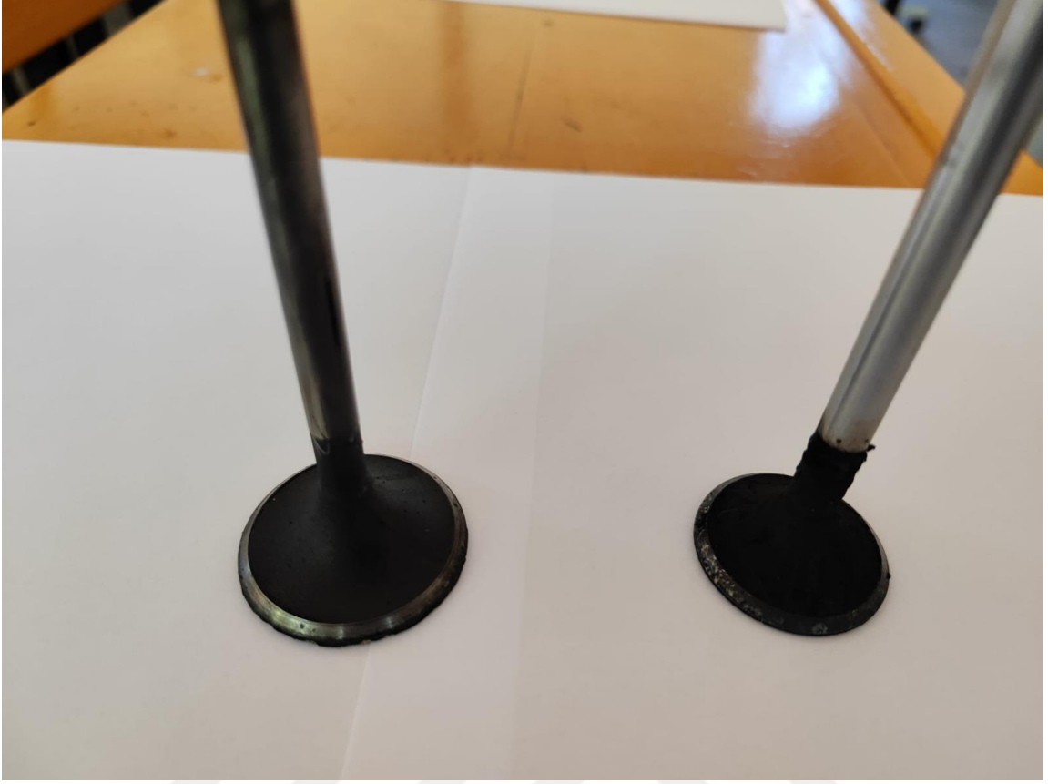
Şekil 6. 26. 60 saatlik D25ALY75 yakıtıyla çalışma sonucunda emme ve egzoz supabının oturma yüzeylerinin görünüşü
