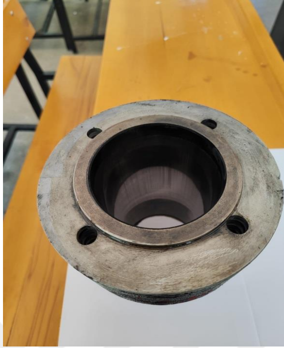
Şekil 6. 28. 60 saatlik D25ALY75 yakıtıyla çalışma sonucunda silindirin görünüşü
