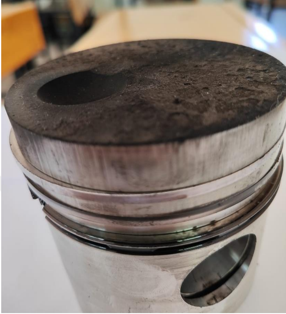
Şekil 6. 31. 60 saatlik D25ALY75 yakıtıyla çalışma sonucunda pistonun görünüşü
