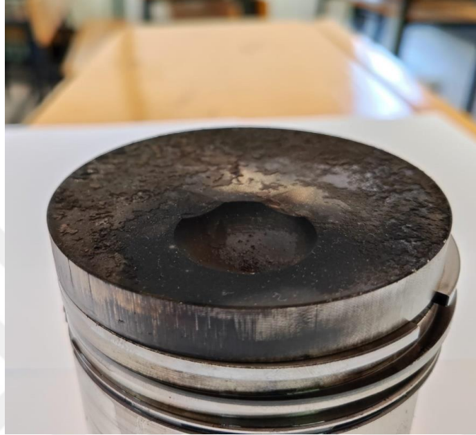
Şekil 6. 40. 60 saatlik D25ALY75DEE7 yakıtıyla çalışma sonucunda piston görünüşü
