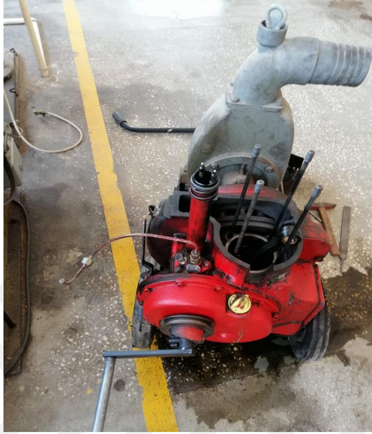
Şekil 5. 12. Pancer motor sökülmüş hali
