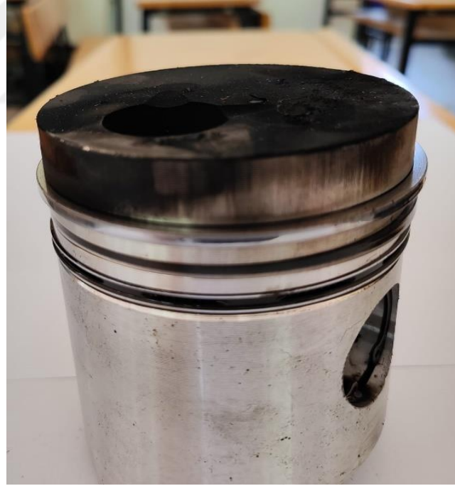
Şekil 6. 21. 60 saatlik D100 yakıtıyla çalışma sonucunda piston görünüşü
