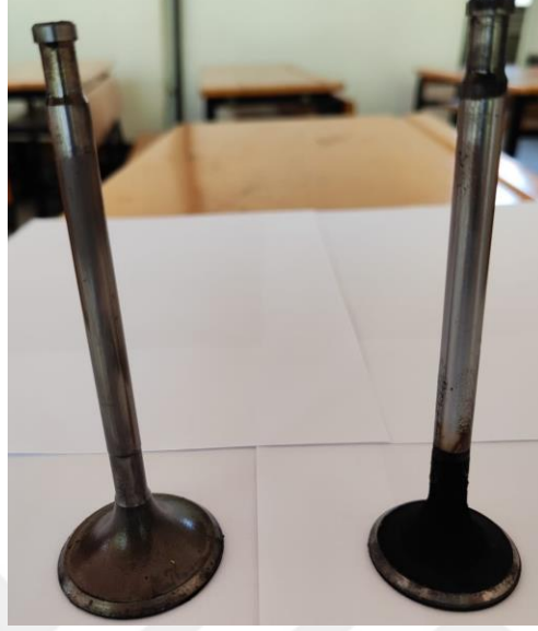
Şekil 6. 16. 60 saatlik D100 yakıtıyla çalışma sonucunda emme ve egzoz supabının görünüşü
