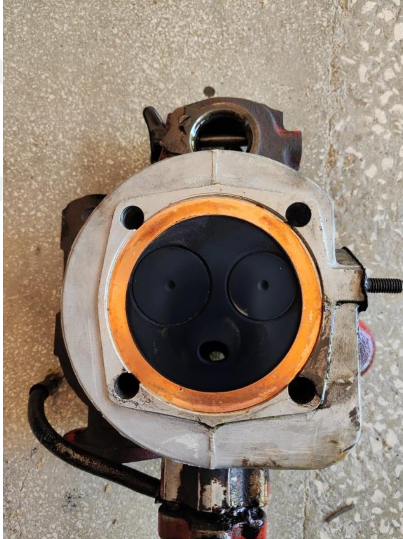
Şekil 6. 15. 60 saatlik D100 yakıtıyla çalışma sonucunda silindir üst kapağının görüntüsü
