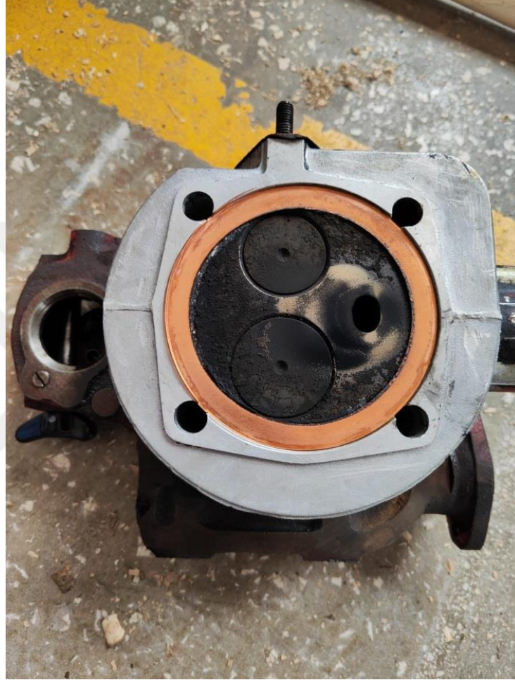
Şekil 6. 35. 60 saatlik D25ALY75DEE7 yakıtıyla çalışma sonucunda silindir üst kapağının görüntüsü
