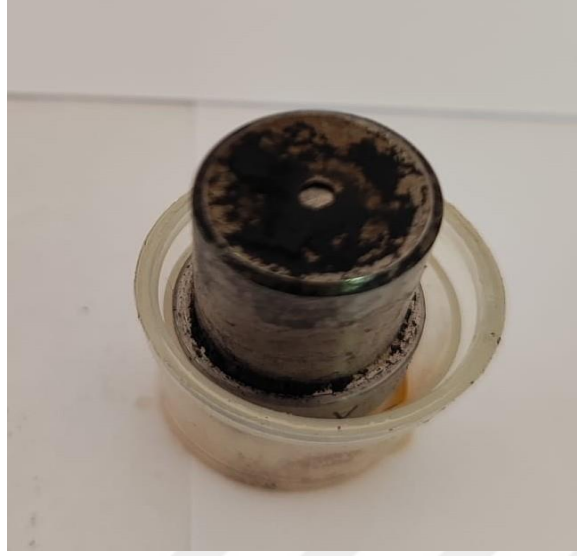
Şekil 6. 22. 60 saatlik D100 yakıtıyla çalışma sonucunda enjektör memesi görünüşü
