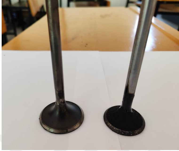
Şekil 6. 36. 60 saatlik D25ALY75DEE7 yakıtıyla çalışma sonucunda emme ve egzoz supabının görünüşü
