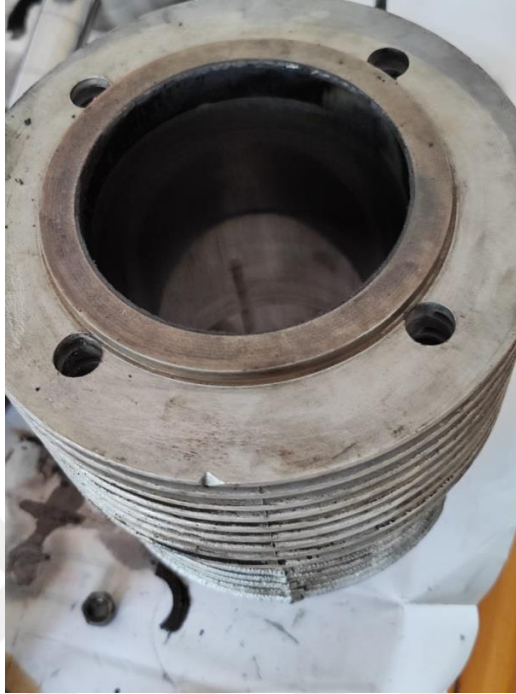
Şekil 6. 38. 60 saatlik D25ALY75DEE7 yakıtıyla çalışma sonucunda silindirin görünüşü
