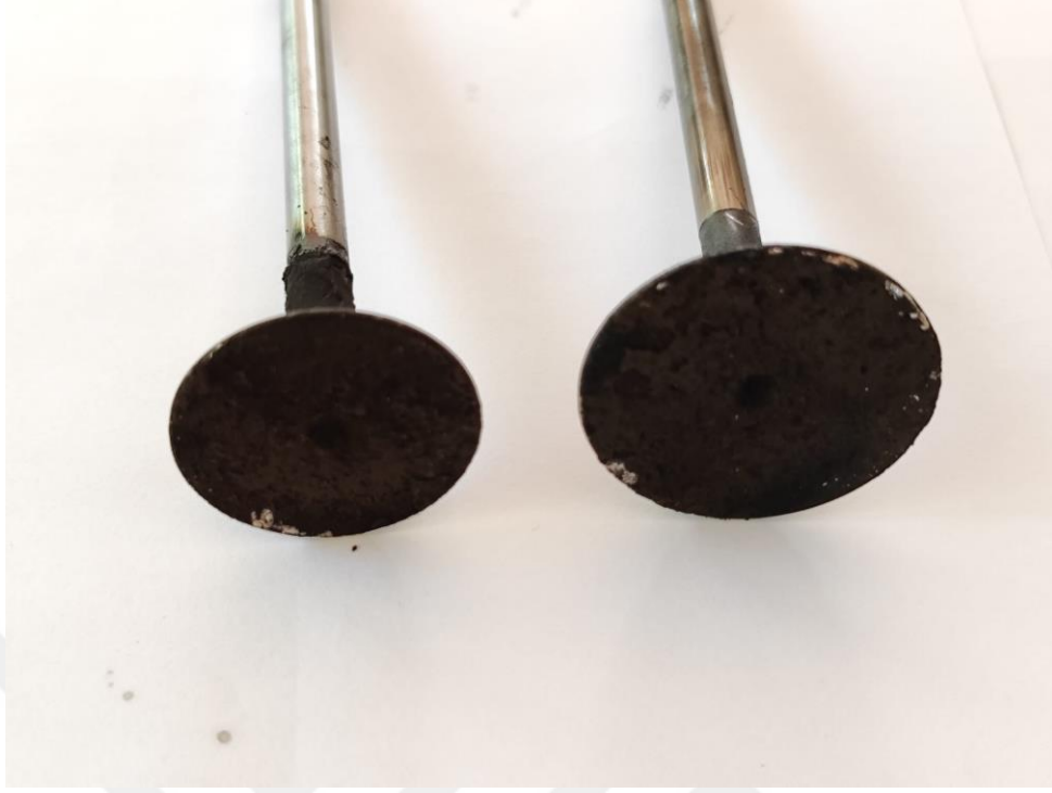
Şekil 6. 27. 60 saatlik D25ALY75 yakıtıyla çalışma sonucunda emme ve egzoz supabının görünüşü
