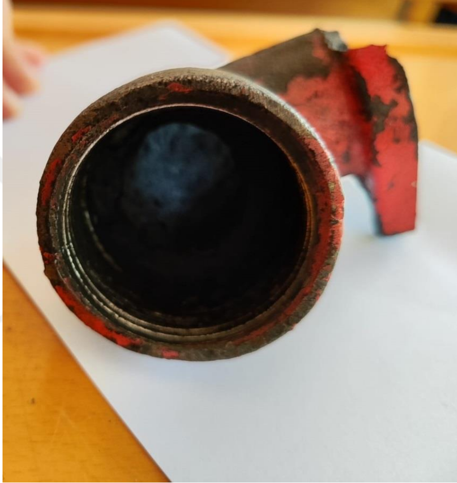
Şekil 6. 43. 60 saatlik D25ALY75DEE7 yakıtıyla çalışma sonucunda egzoz manifoldunun görünüşü
