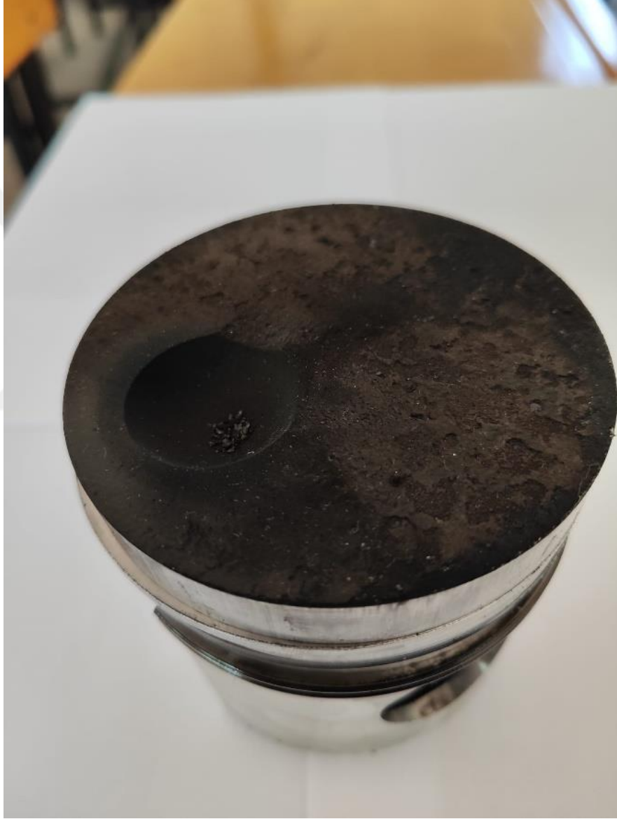
Şekil 6. 30. 60 saatlik D25ALY75 yakıtıyla çalışma sonucunda pistonun görünüşü
