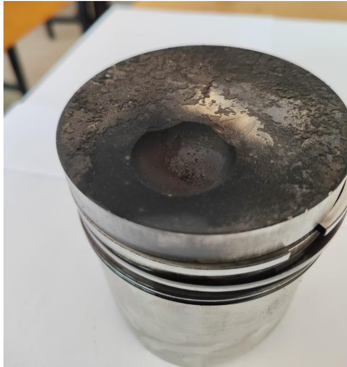
Şekil 6. 41. 60 saatlik D25ALY75DEE7 yakıtıyla çalışma sonucunda piston görünüşü
