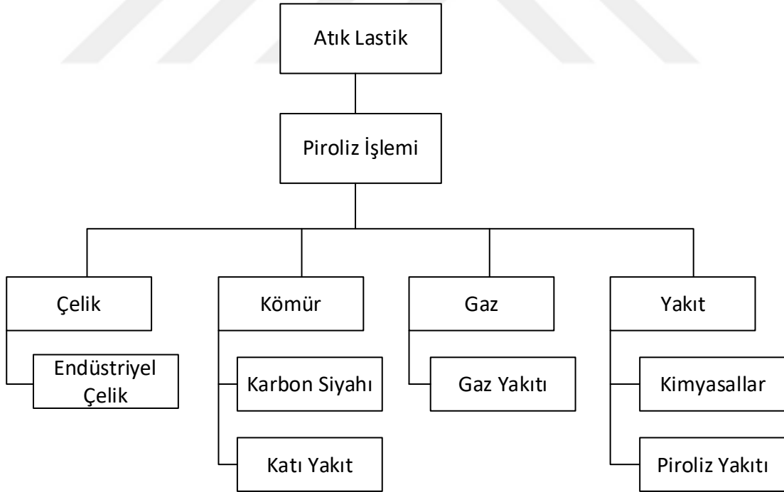
Şekil 2. 11. Atık lastiklerden piroliz işlemi sonrasında oluşan ürünlerin şematik gösterimi
