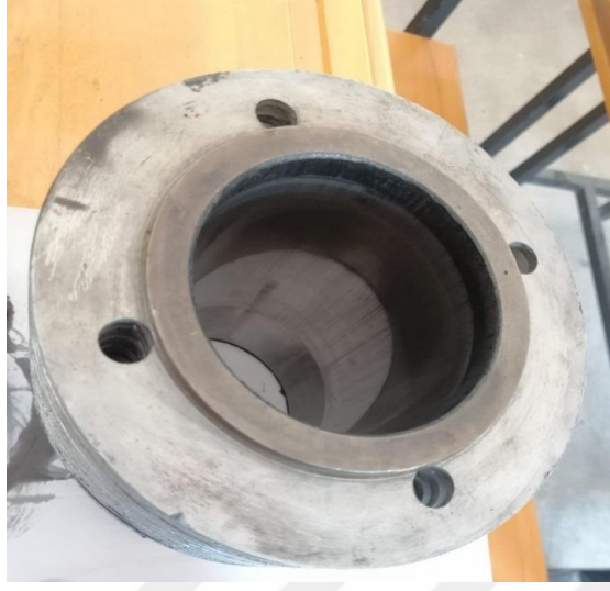
Şekil 6. 18. 60 saatlik D100 yakıtıyla çalışma sonucunda silindirin görünüşü
