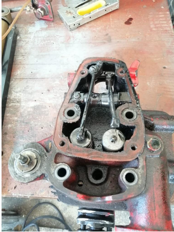
Şekil 6. 34 60 saatlik D25ALY75 yakıtıyla çalışma sonucunda külbütörlerin görünüşü
