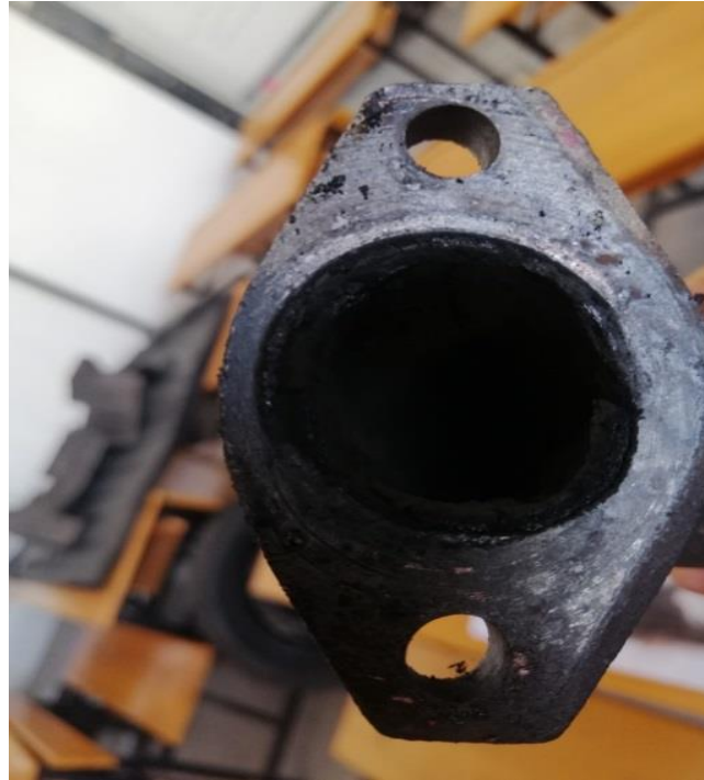
Şekil 6. 33. 60 saatlik D25ALY75 yakıtıyla çalışma sonucunda egzoz manifoldunun görünüşü
