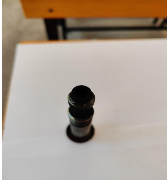
Şekil 6. 19. 60 saatlik D100 yakıtıyla çalışma sonucunda ateşleme fitilinin görünüşü
