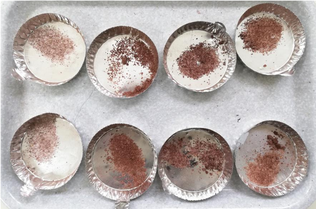
Şekil 11. 6. Ay Periyodunda 38°C ve 48 °C'de Kekleşme Derecesi Analizindeki Elek Üstü Örneklerinin Görüntüleri **
