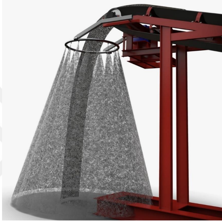
Şekil 2.24. Halka ring uygulaması şematik gösterimi.
