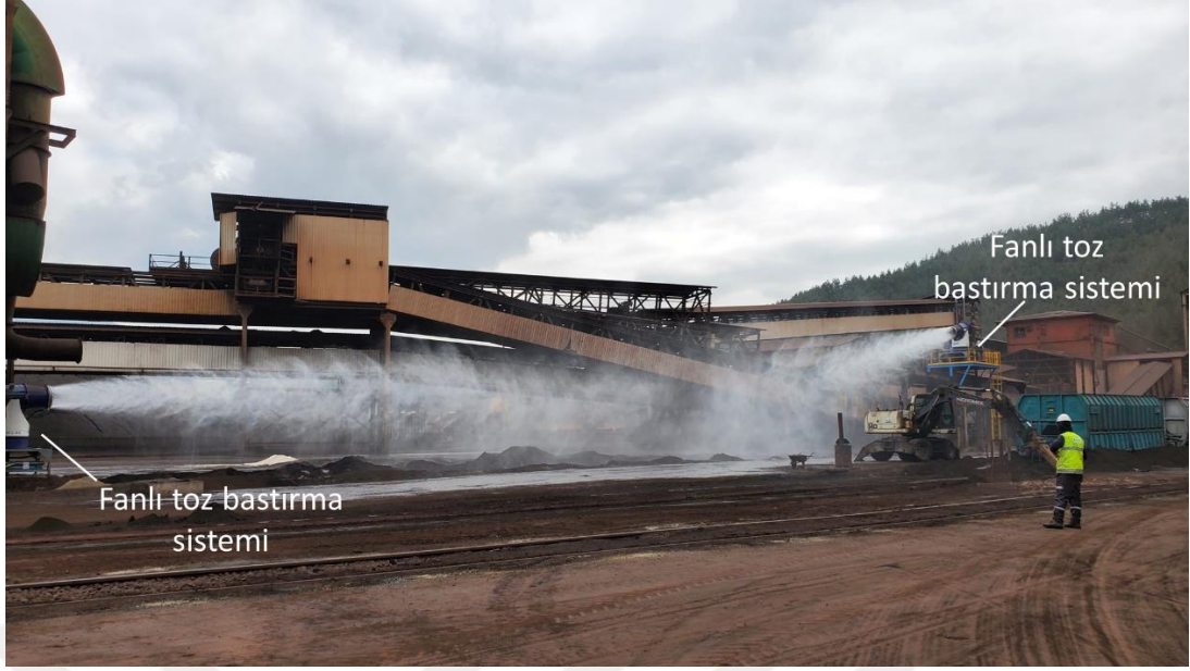
Şekil 2.28. Kardemir’de sabit tip fanlı toz bastırma uygulaması.
