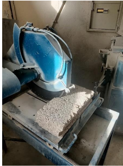
Şekil 2.79. Bims beton kesimine ait görsel
