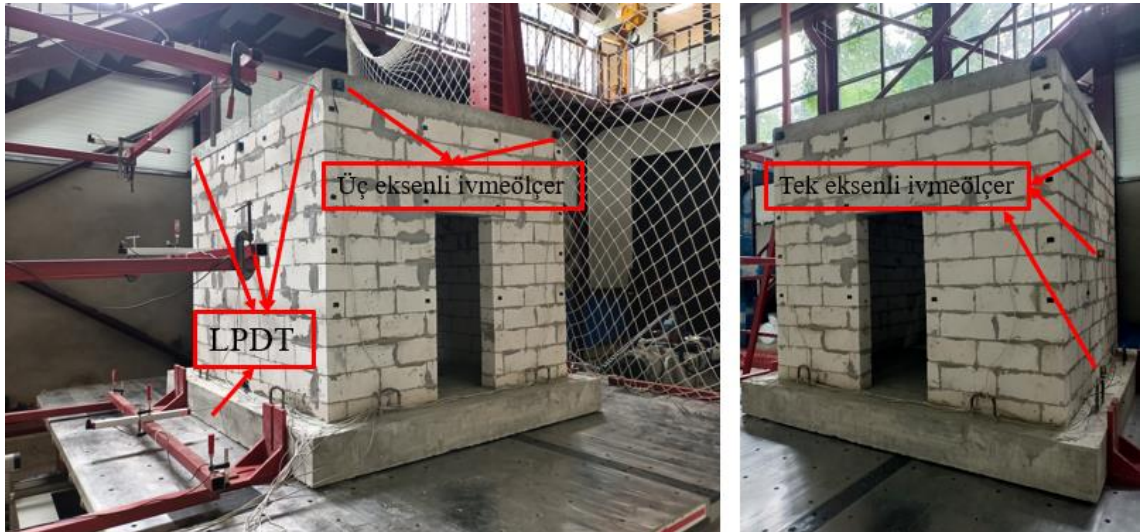
Şekil 2.106. Gaz beton modeline ait deney düzeneği
