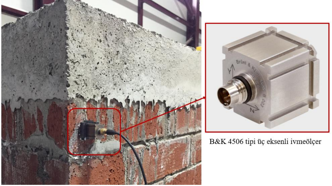
Şekil 1.13. Piezoelektrik tipi üçeksenli ivmeölçer
