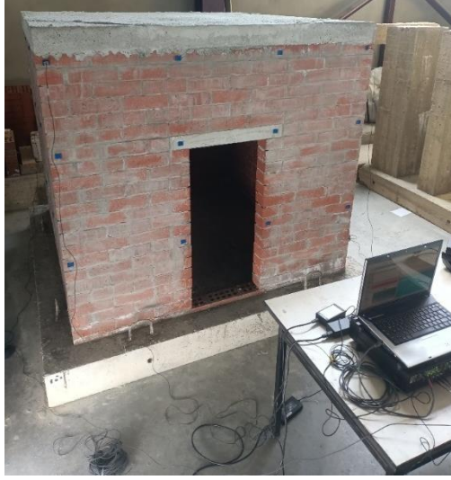
Şekil 2.42. DMA ölçümlerine ait görsel
