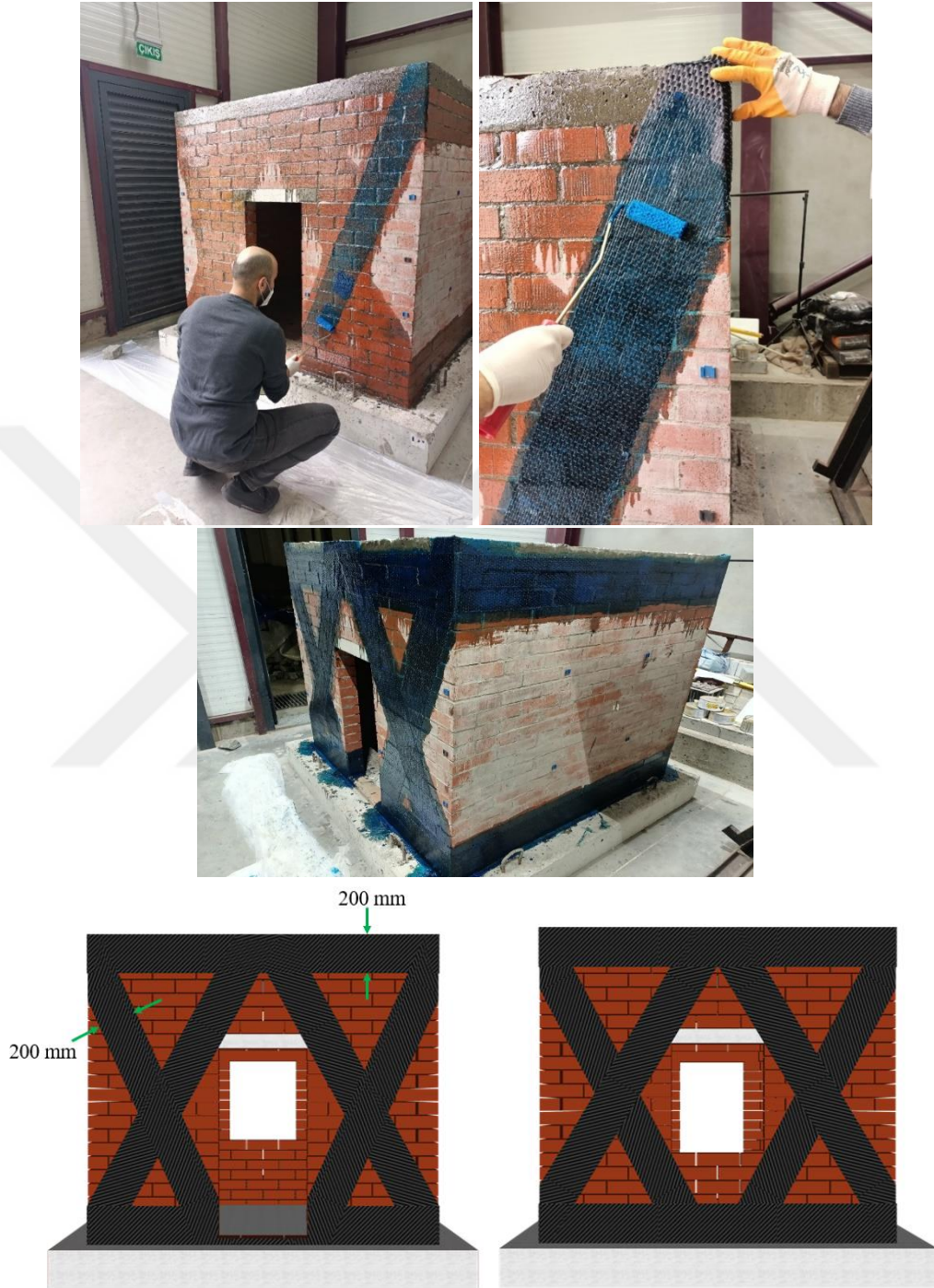
(c) Epoksi ve LP malzemenin uygulanması
