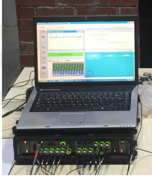
Şekil 1.14. B&K 3560 C tipi 17 kanallı veri toplama ünitesi
