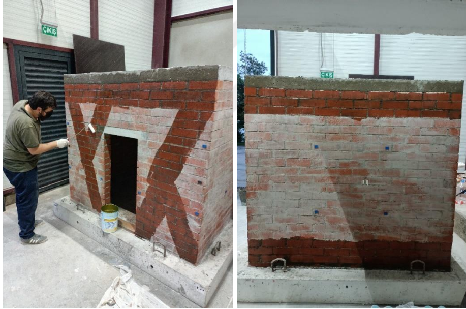
(b) Astar malzemesinin elemanlara sürülmesi
