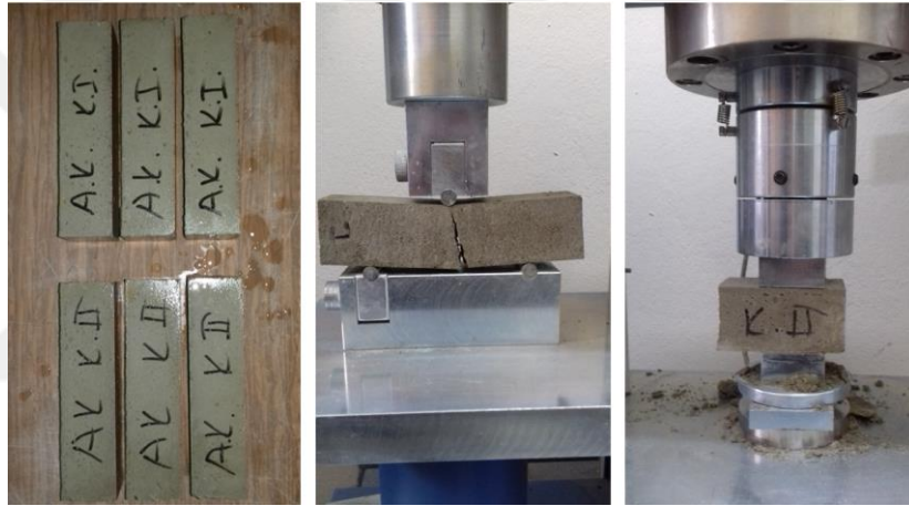
Şekil 2.3. Harç numunelerinin eğilmede çekme ve basınç deneylerine ait görseller
