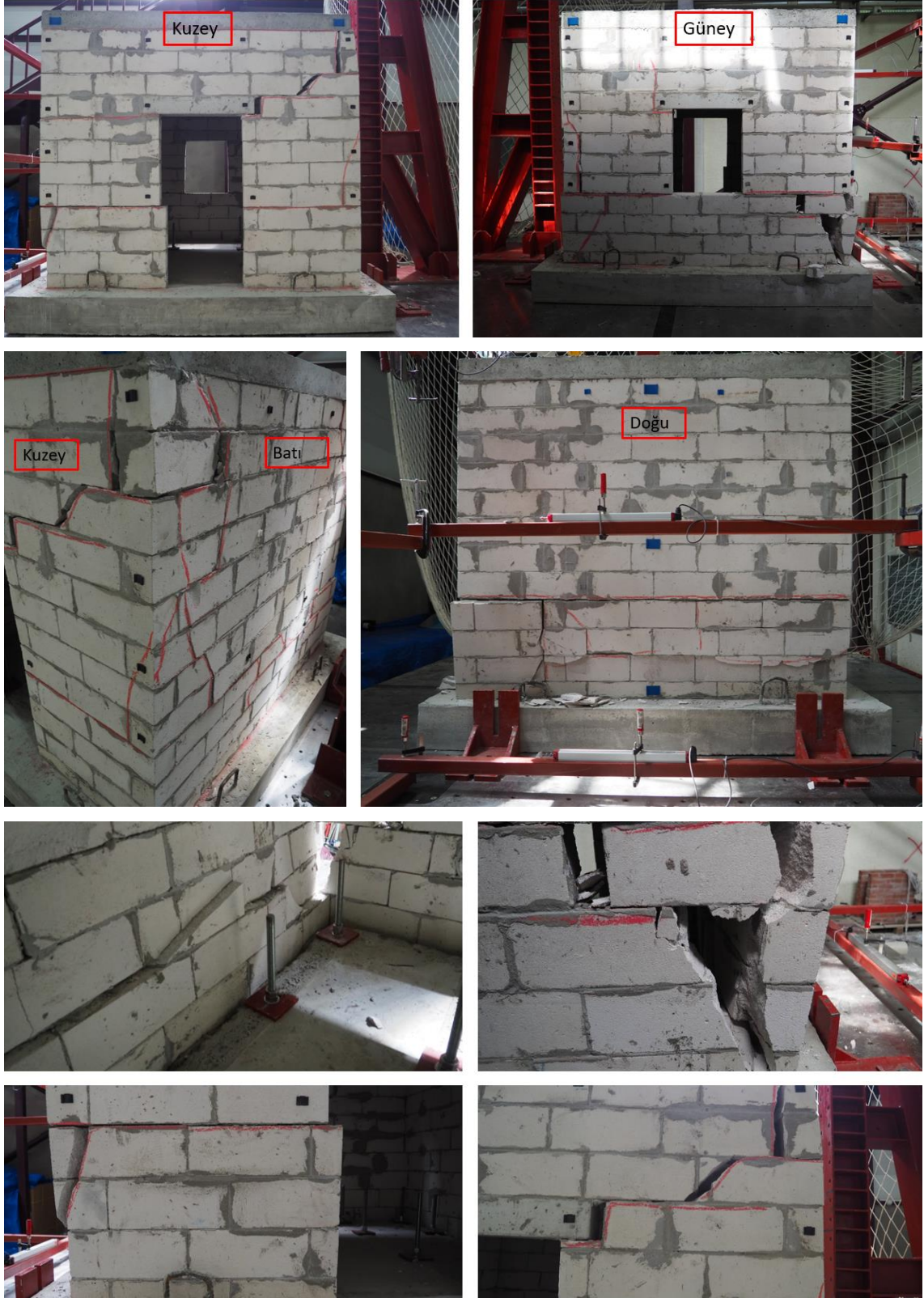
Şekil 2.108. DS-5 tipi hasar durumu için deney numunesinin dış yüzeyinin hasar modeli
