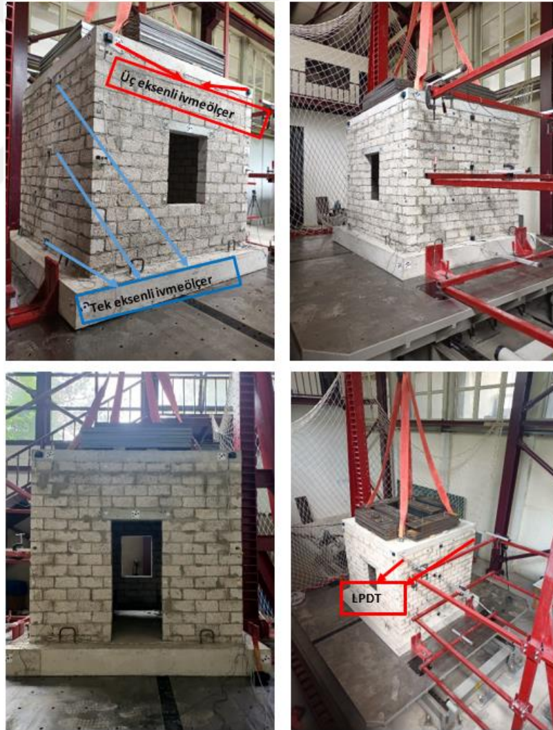
Şekil 2.86. Bims modeline ait deney düzeneği
