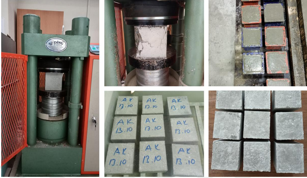
Şekil 2.4. Beton numunelerin alınması ve malzeme testi
