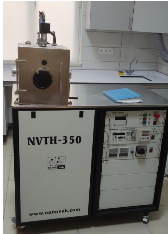
Şekil 3.9. Al metal kaplamasında kullanılan PVD cihazının fotoğrafı.
