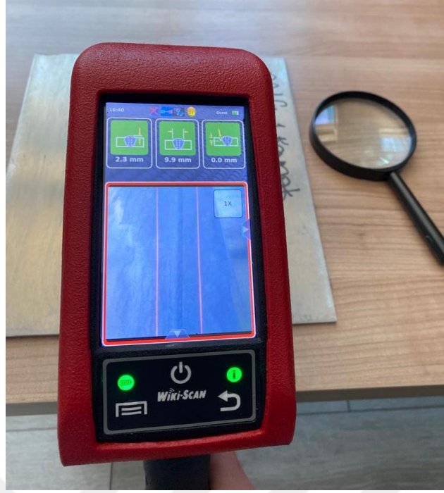
Şekil 5.5. Servo-Robot marka Wiki-Scan lazerli kaynak ölçüm cihazı ve mercek.
