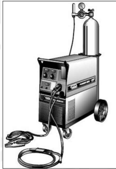
Şekil 3.3. MIG 350MP ünitesinin güç kaynağı [27].
