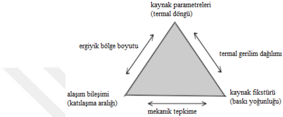
Şekil 3.31. Kaynakta katılma çatlama etkileyen proses parametreleri arasındaki etkileşimi gösteren diyagram [44].
