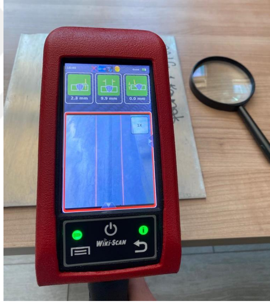
Şekil 6.1. Kaynak dikişi ölçüleri gösterimi.
