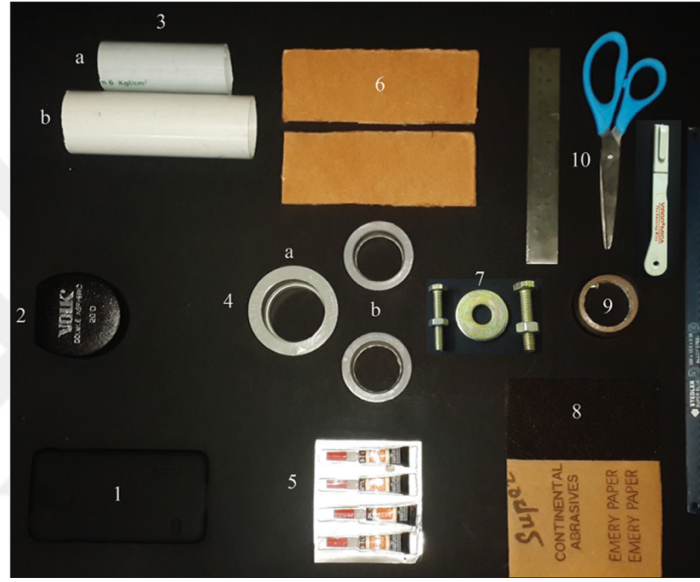
Şekil 22 DIYretCam yapımında kullanılan malzemeler.
