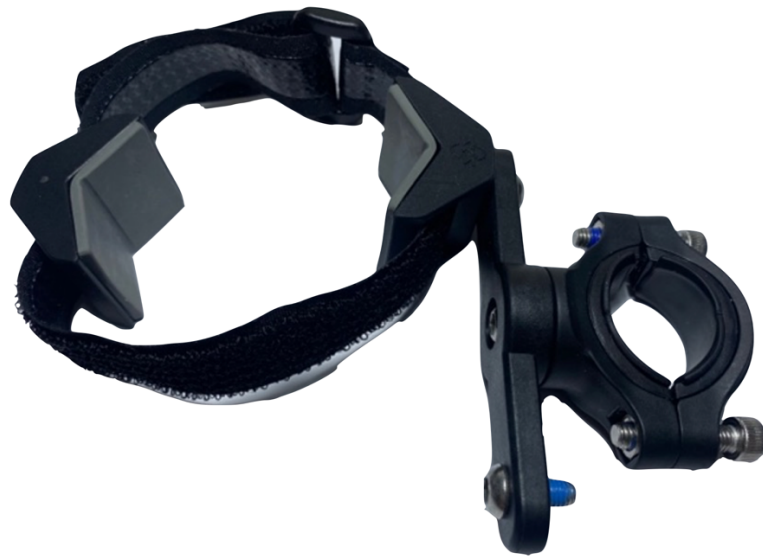
Şekil 29 Parçalar birleştirilerek oluşturulan lens taşıyıcı
