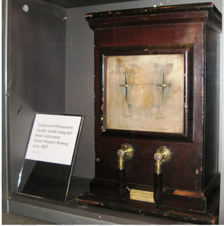
Resim 2: Cooke ve Wheatstone tarafından yapılan telgraf makinelerine bir örnek. ( https://upload.wikimedia.org/wikipedia/commons/e/ef/GWR_Cooke_and_Wheatstone_double_needle_telegraph_instrument.jpg )
