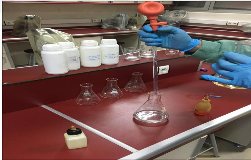
Şekil 3.4 Laboratuvar ortamında alkalinite tayini
