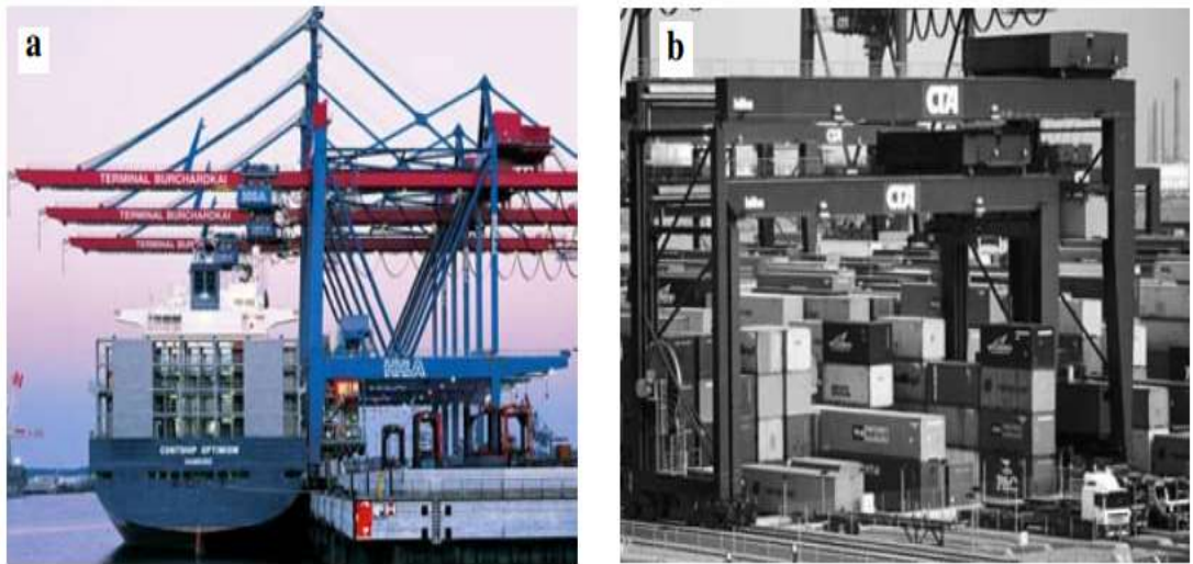
Şekil 1. 2 a) Rıhtım vinci ve b) İstifleme vinci (Steenken ve diğ., 2004)
