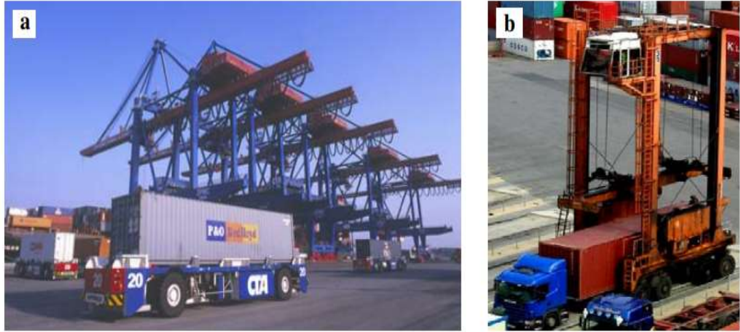
Şekil 1.3 Yatay taşıma şu anlama gelir: Otomatik yönlendirmeli araç ve üstüne binilir taşıyıcı. a) AGV'ler (rıhtım vinçlerinin önünde), b) Straddle taşıyıcı (Steenken ve diğ., 2004).
