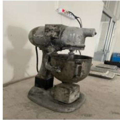
Şekil 2.8. Hazırlanan Kuru Karışım ve Deneylerde Kullanılan Hobart Mikseri
