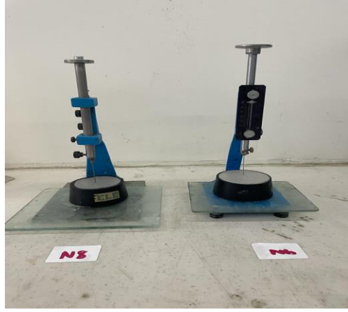
Şekil 2.11. Vicat Aleti ile Priz Süresi Belirlenmesi
